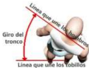
Figura 28: Ángulo formado por el giro del tronco (Método de manipulación de cargas INSHT)
