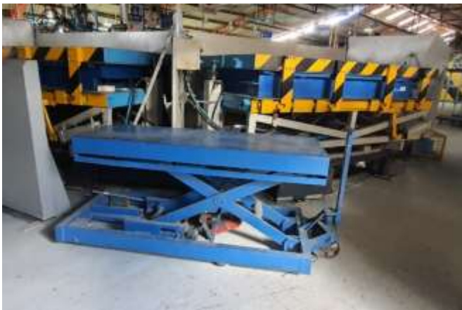
Figura 60: Mesa de montaje artesanal en contacto con carrusel Fuente: Javier Rodas López
