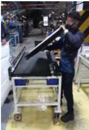
Figura 80: Armado de contrapuestas (paso 1)
