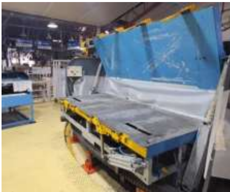
Figura 55: Mesa del carrusel abierta vista en perspectiva
