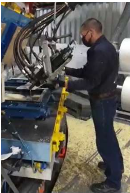
Figura 73: Inyección de poliuretano (paso 1)
