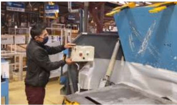
Figura 126: Cerrado de mesa con accionador bi-manual (vista lateral) Fuente: Javier Rodas López
