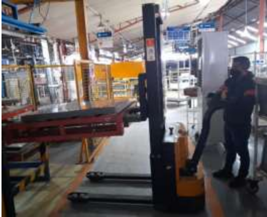
Figura 115: Alimentación de láminas a la dobladora con apilador Thor (paso 2)
