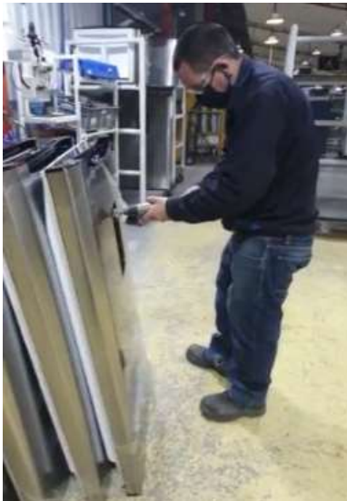
Figura 93: Colocado de grifo (paso 1)
