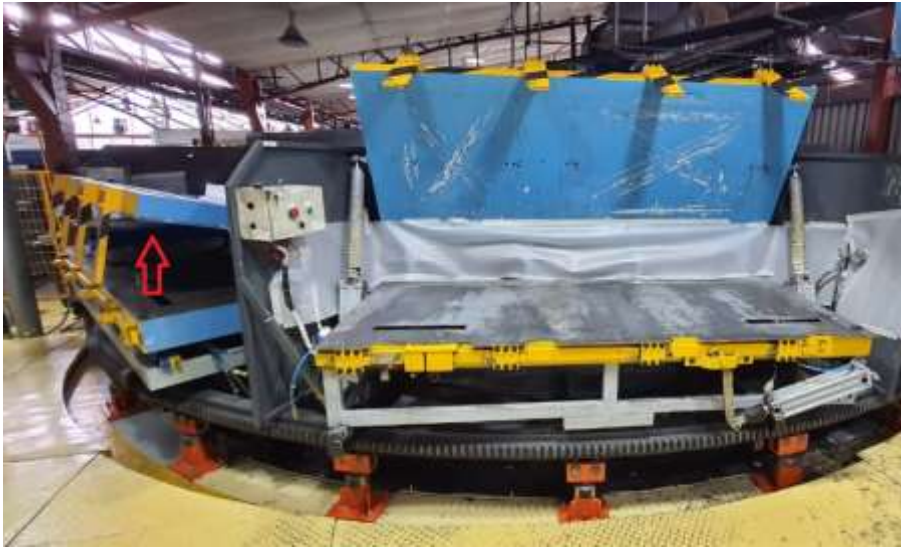
Figura 128: Mesa de carrusel estática a media apertura Fuente: Javier Rodas López
