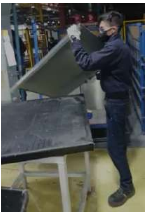
Figura 47: Paso 2 (Desprendimiento de plástico)
