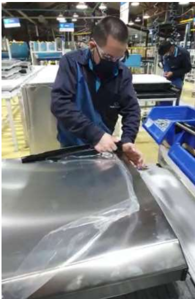
Figura 91: Colocado de manija (paso 4) Fuente: Javier Rodas López
