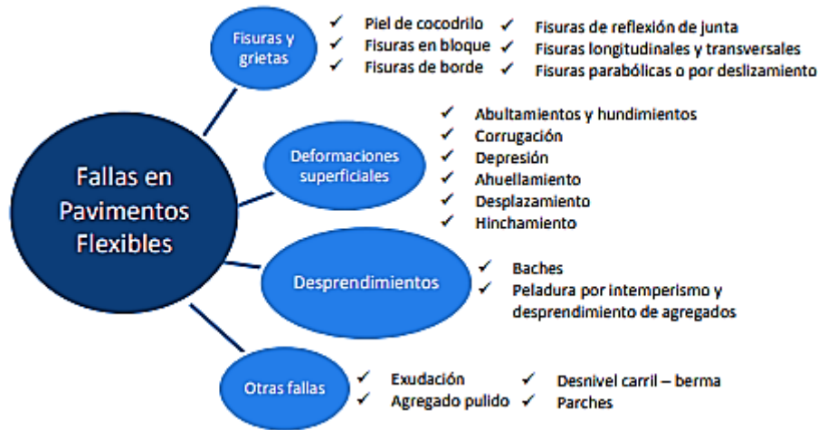
Figura 3. Tipos de fallas en pavimentos flexibles. Fuentes (Rodríguez, 1993).
