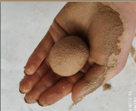
Ilustración 26. Test cantidad de arcilla. MUESTRA 4. Benalcázar, M., Zeas, V.,2020.
