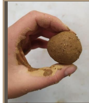
Ilustración 31. Test de brillo de la tierra. MUESTRA 3. Benalcázar, M., Zeas, V.,2020.
