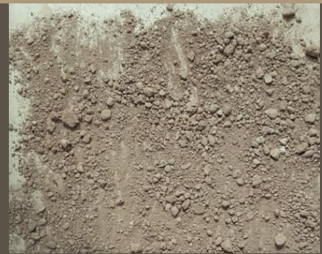
Ilustración 12. Test visual de la tierra, MUESTRA 2. Benalcázar, M., Zeas, V., 2020.
