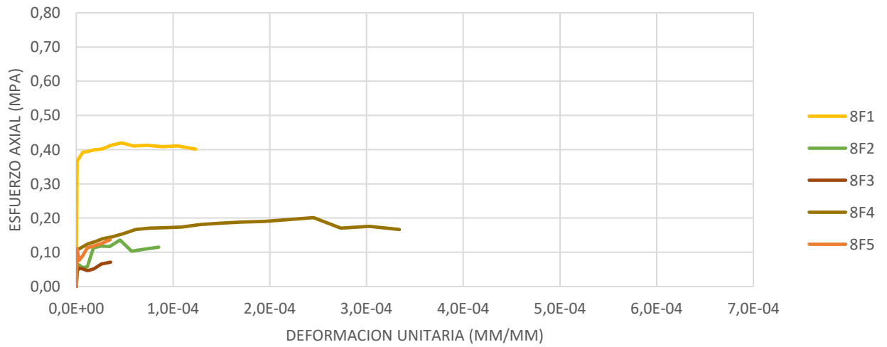
Gráfica 31. Diagrama Esfuerzo/Deformación Unitaria. Ensayo de Flexión. (ADOBE TIPO 8). Benalcázar, M., Zeas, V., 2021
