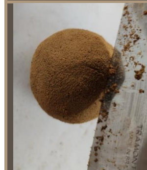
Ilustración 33. Test de brillo de la tierra. MUESTRA 3. Benalcázar, M., Zeas, V.,2020.
