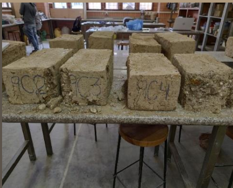
Ilustración 140. Adobe tradicional sometido a Compresión. Benalcázar, M., Zeas, V., 2020.
