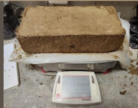
Ilustración 148. Ensayo de Absorción a los 20 min. Adobe 5A1. Benalcázar, M., Zeas, V., 2021.
