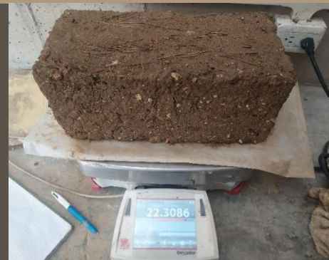
Ilustración 149. Ensayo de Absorción 20min (ADOBE TRADICIONAL) Benalcázar, M., Zeas, V., 2021
