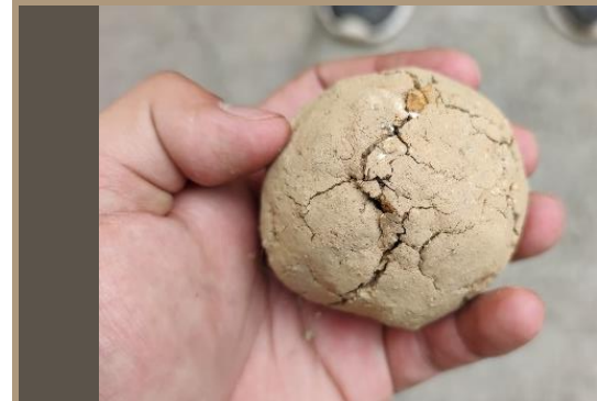
Ilustración 45. Test de caída de esfera. MUESTRA 3. Benalcázar, M., Zeas, V.,2020.
