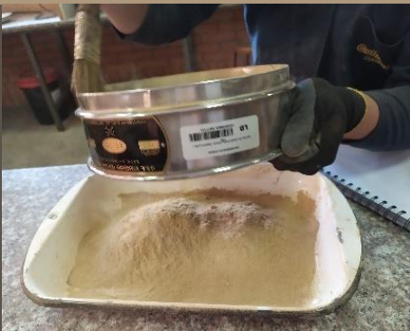
Ilustración 83. Ensayo de granulometría. Limpieza de tamices. MUESTRA 3. Benalcázar, M., Zeas, V.,2020.
