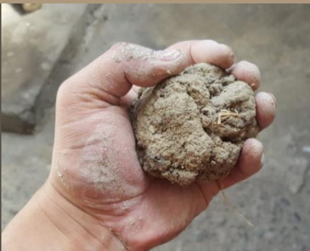
Ilustración 24. Test cantidad de arcilla. MUESTRA 2. Benalcázar, M., Zeas, V.,2020.
