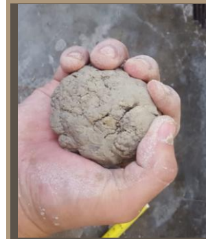
Ilustración 29. Test de brillo de la tierra. MUESTRA 2. Benalcázar, M., Zeas, V.,2020.
