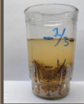
Ilustración 57. Test del vidrio. MUESTRA 3. Benalcázar, M., Zeas, V.,2020.
