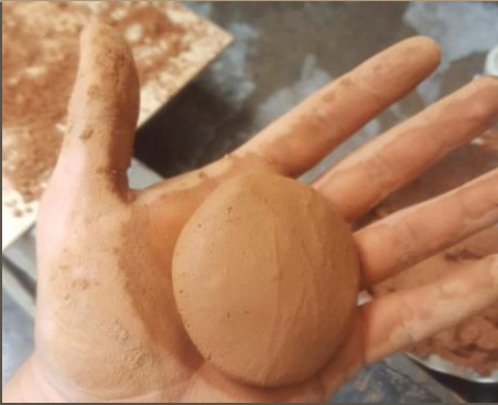
Ilustración 23. Test cantidad de arcilla. MUESTRA 1. Benalcázar, M., Zeas, V.,2020.
