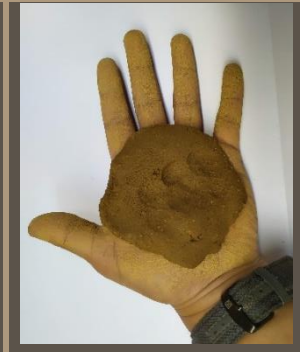
Ilustración 76. Test exudación de la tierra. MUESTRA 3. Benalcázar, M., Zeas, V., 2020.
