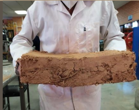
Ilustración 110. Tamaño de cabuya. Adobe con cabuya 10 a 15cm ensayo de flexión. Benalcázar, M., Zeas, V.,2020.
