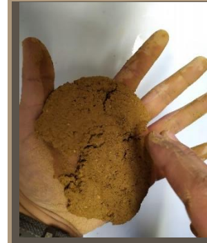
Ilustración 75. Test exudación de la tierra. MUESTRA 3. Benalcázar, M., Zeas, V., 2020.
