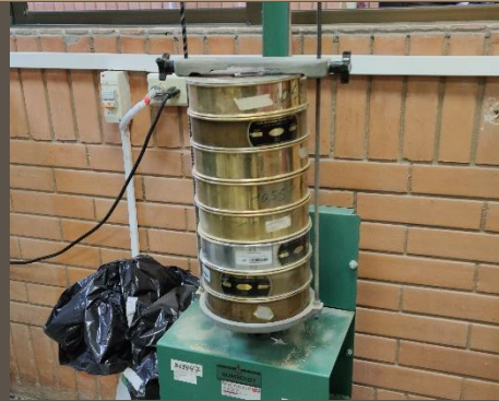
Ilustración 80. Ensayo de granulometría. Pesaje de masa retenida en cada tamiz. MUESTRA 4. Benalcázar, M., Zeas, V.,2020.
