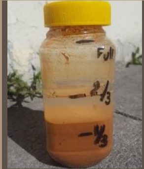
Ilustración 50. Test del vidrio. MUESTRA 1. Benalcázar, M., Zeas, V.,2020.
