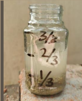
Ilustración 53. Test del vidrio. MUESTRA 2. Benalcázar, M., Zeas, V.,2020.
