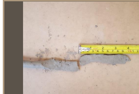
Ilustración 36. Test contenido de arcilla. MUESTRA 2. Benalcázar, M., Zeas, V.,2020.
