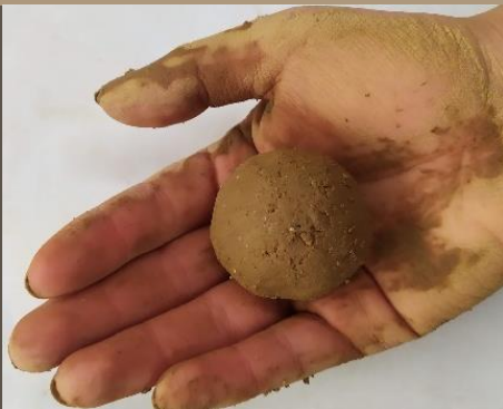
Ilustración 25. Test cantidad de arcilla. MUESTRA 3. Benalcázar, M., Zeas, V.,2020.
