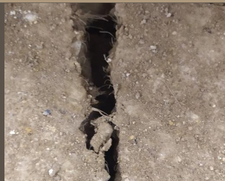
Ilustración 142. Adobe tradicional sometido a flexión. Benalcázar, M., Zeas, V.,2020.
