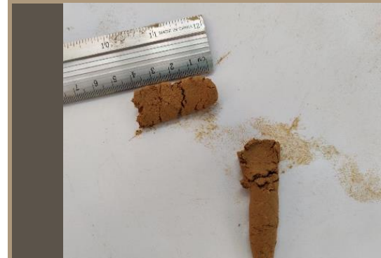
Ilustración 37. Test contenido de arcilla. MUESTRA 3. Benalcázar, M., Zeas, V.,2020.
