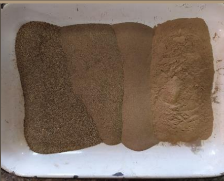
Ilustración 85. Ensayo de granulometría. MUESTRA 3. Benalcázar, M., Zeas, V.,2020.
