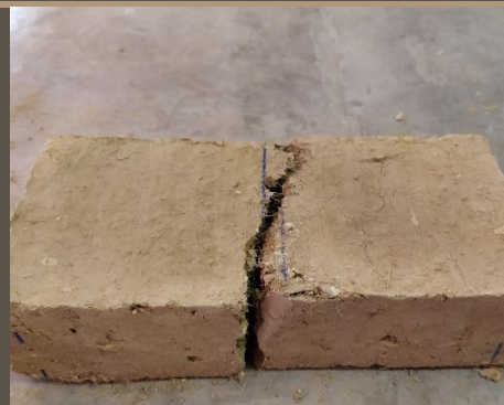
Ilustración 144. Adobe tradicional sometido a flexión. Benalcázar, M., Zeas, V.,2020.
