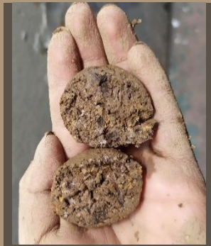
Ilustración 32. Test de brillo de la tierra. MUESTRA 3. Benalcázar, M., Zeas,2020.
