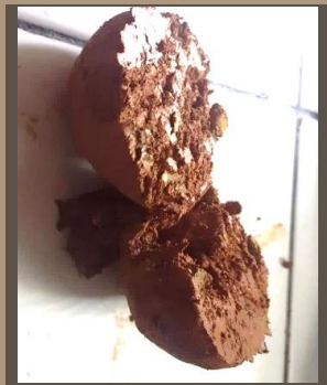
Ilustración 28. Test de brillo de la tierra. MUESTRA 1. Benalcázar, M., Zeas, V.,2020
