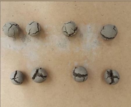
Ilustración 40. Test de resistencia Seca. MUESTRA 2. Benalcázar, M., Zeas, V., 2020.
