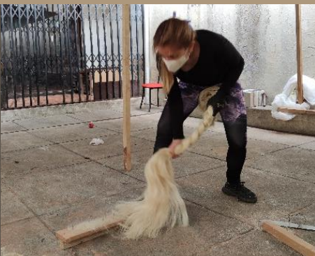
Ilustración 118. Proceso de peinado de la cabuya. Benalcázar, M., Zeas, V.,2020.
