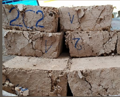
Ilustración 136. Adobes mejorados después del ensayo de Compresión. Tipo 1 y 2. Benalcázar, M., Zeas, V., 2020.
