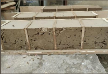
Ilustración 95. Fabricación de cubos de 10cm de arista. Benalcázar, M., Zeas, V.,2001
