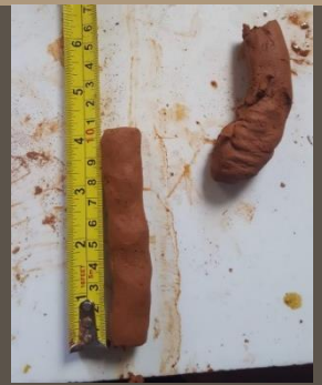
Ilustración 64. Test del rollo. MUESTRA 1. Benalcázar, M., Zeas, V., 2020.
