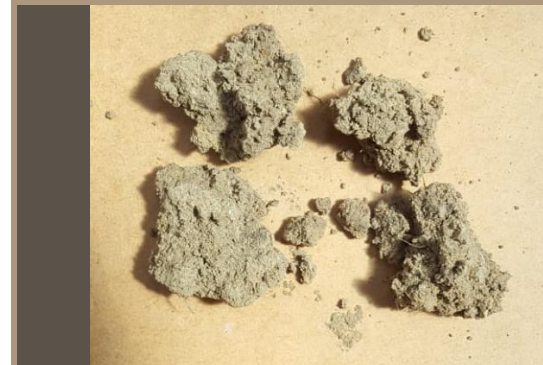
Ilustración 44. Test de caída de esfera. MUESTRA 2. Benalcázar, M., Zeas, V.,2020.
