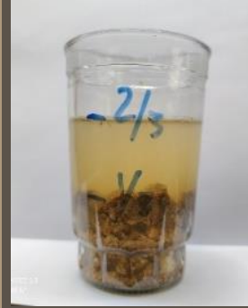
Ilustración 61. Test del vidrio. MUESTRA 4. Benalcázar, M., Zeas, V.,2020.
