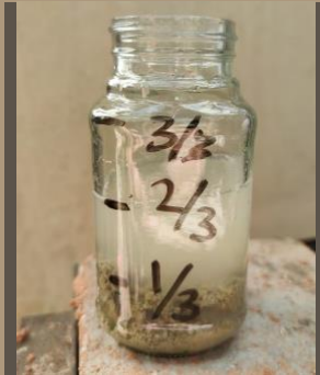
Ilustración 54. Test del vidrio. MUESTRA 2. Benalcázar, M., Zeas, V.,2020.
