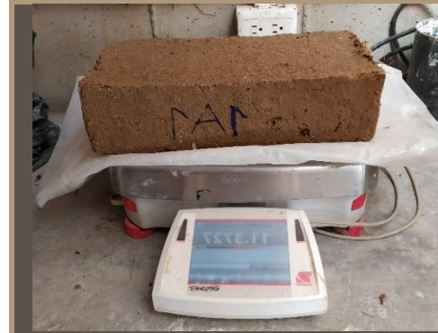
Ilustración 147. Ensayo de Absorción a los 20 min. Adobe 1A1. Benalcázar, M., Zeas, V., 2021.
