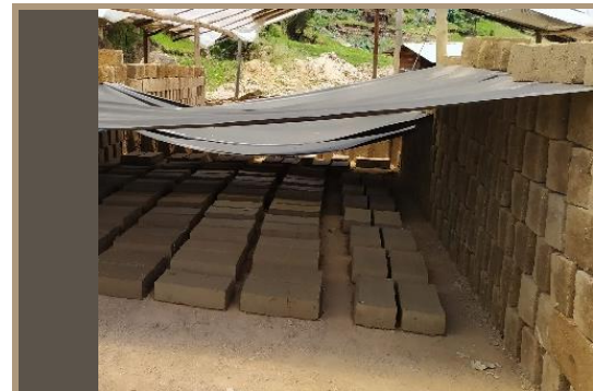
Ilustración 113. Cuidados importantes. Ejemplo de cubierta. Benalcázar, M., Zeas, V., 2020.
