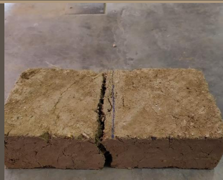
Ilustración 143. Adobe tradicional sometido a flexión. Benalcázar, M., Zeas, V.,2020.
