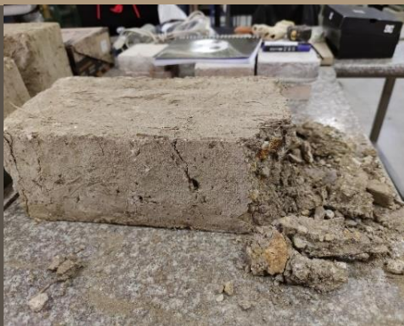
Ilustración 141. Adobe tradicional sometido a Compresión. Benalcázar, M., Zeas, V., 2020.
