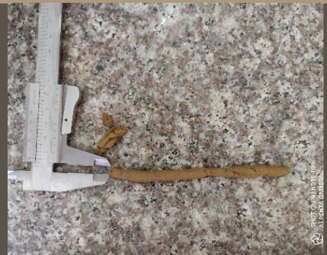
Ilustración 94. Ensayo de límite plástico. MUESTRA 3. Benalcázar, M., Zeas, V.,2020.
