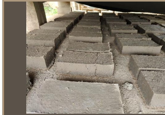
Ilustración 133. Proceso de secado de los adobes. Secado bajo sombra. Benalcázar, M., Zeas, V., 2020.
