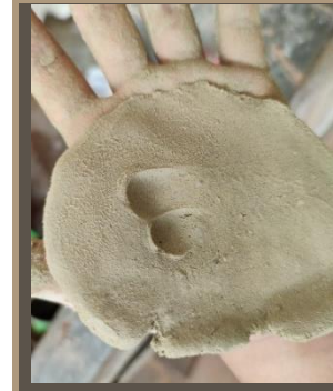
Ilustración 73. Test exudación de la tierra. MUESTRA 2. Benalcázar, M., Zeas, V., 2020.
