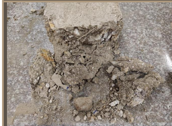
Ilustración 146. Material orgánico en Adobe Tradicional de prueba. Benalcázar, M., Zeas, V., 2020.
