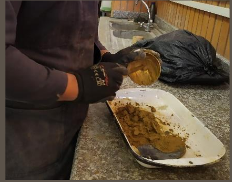
Ilustración 88. Ensayo de límite líquido. MUESTRA 3. Benalcázar, M., Zeas, V.,2020.
