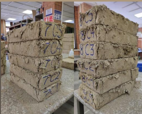
Ilustración 139. Adobes mejorados después del ensayo de Compresión. Tipo 7 y 8. Benalcázar, M., Zeas, V., 2020.
