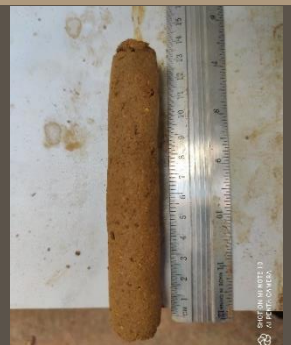
Ilustración 68. Test del rollo. MUESTRA 3. Benalcázar, M., Zeas, V., 2020.
