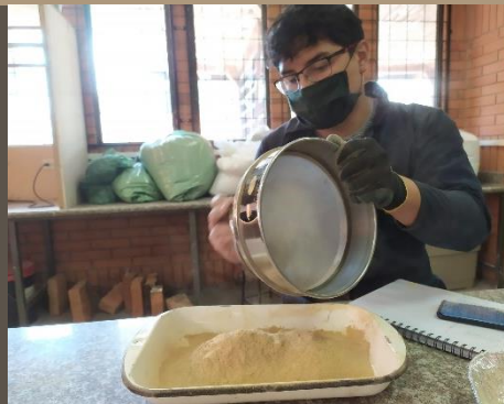
Ilustración 84. Ensayo de granulometría. Limpieza de tamices. MUESTRA 4. Benalcázar, M., Zeas, V.,2020.
