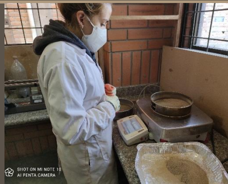
Ilustración 82. Ensayo de granulometría. Pesaje de masa retenida en cada tamiz. MUESTRA 4. Benalcázar, M., Zeas, V.,2020.
