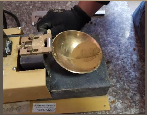
Ilustración 90. Ensayo de límite líquido. MUESTRA 3. Benalcázar, M., Zeas, V.,2020.
