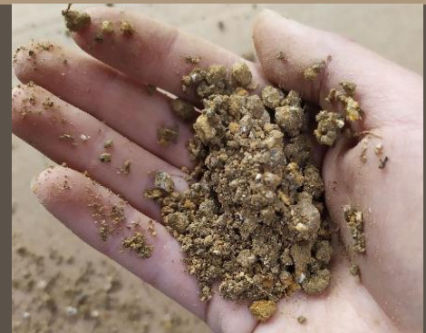
Ilustración 22. Test - Tacto de la tierra. MUESTRA 4. Benalcázar, M., Zeas, V.,2020.
