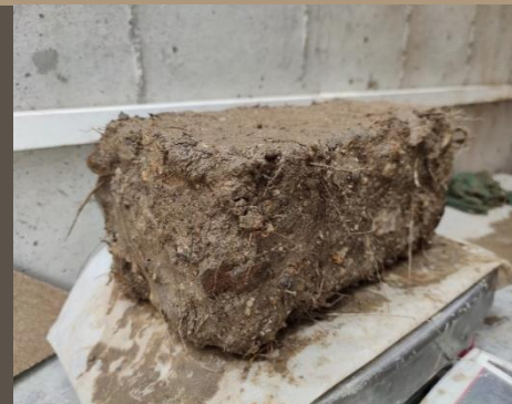
Ilustración 150. Ensayo de Absorción 24H (ADOBE TRADICIONAL). Benalcázar, M., Zeas, V., 2021
