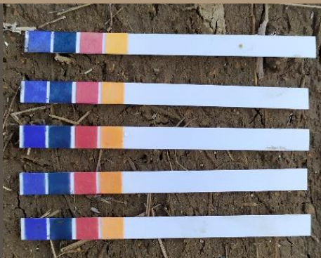
Ilustración 106..Ensayo de Dosificación de Cal. Resultados. Benalcázar, M., Zeas, V.,2020.
