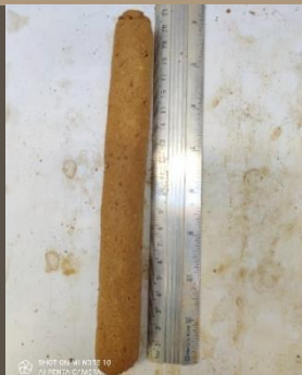
Ilustración 67. Test del rollo. MUESTRA 3. Benalcázar, M., Zeas, V., 2020.
