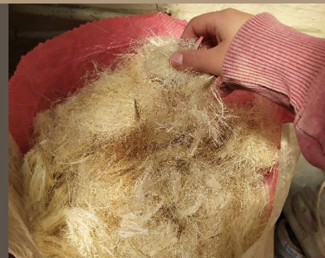
Ilustración 111. Muestras de cabuya cortada 4cm. Benalcázar, M., Zeas, V.,2020.
