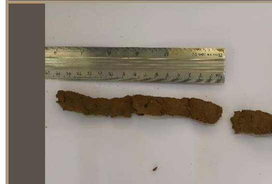
Ilustración 38. Test contenido de arcilla. MUESTRA 4. Benalcázar, M., Zeas, V.,2020.
