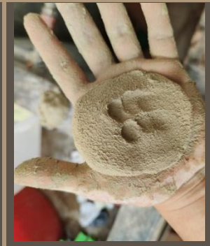
Ilustración 74. Test exudación de la tierra. MUESTRA 2. Benalcázar, M., Zeas, V., 2020.
