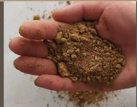
Ilustración 21. Test - Tacto de la tierra. MUESTRA 3. Benalcázar, M., Zeas, V.,2020.
