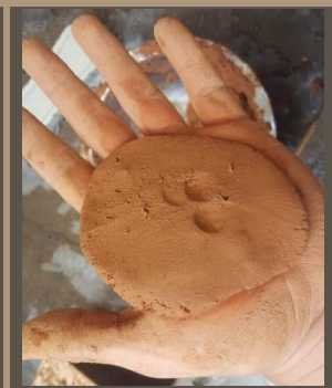
Ilustración 72. Test exudación de la tierra. MUESTRA 1. Benalcázar, M., Zeas, V., 2020.
