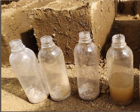
Ilustración 104. Proceso de ensayo de Dosificación de la Cal. Paso 1. Benalcázar, M., Zeas, V.,2020.
