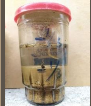
Ilustración 58. Test del vidrio. MUESTRA 3. Benalcázar, M., Zeas, V.,2020.
