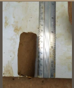
Ilustración 70. Test del rollo. MUESTRA 4. Benalcázar, M., Zeas, V., 2020.
