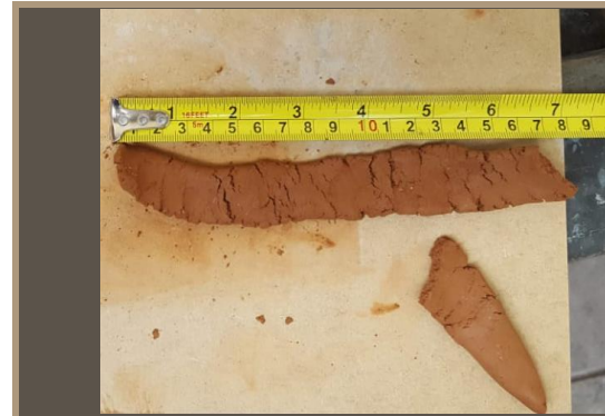
Ilustración 35. Test contenido de arcilla. MUESTRA 1. Benalcázar, M., Zeas, V.,2020.
