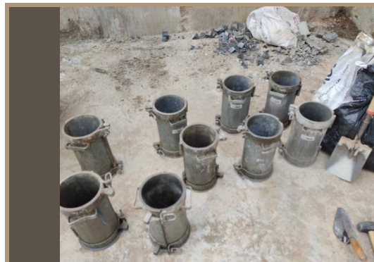
Ilustración 97. Cofres cilíndricos. Benalcázar, M., Zeas, V., 2020.
