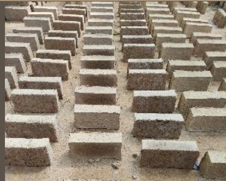
Ilustración 134. Proceso de secado de los adobes. Volteado. Benalcázar, M., Zeas, V., 2020.
