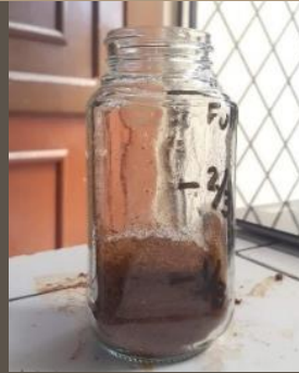
Ilustración 48. Test del vidrio. MUESTRA 1. Benalcázar, M., Zeas, V.,2020.
