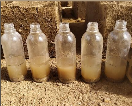
Ilustración 105..Proceso de ensayo de Dosificación de la Cal. Paso 2. Benalcázar, M., Zeas, V.,2020.
