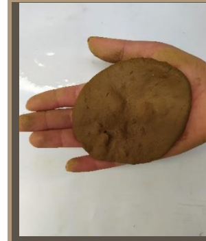
Ilustración 77. Test exudación de la tierra. MUESTRA 4. Benalcázar, M., Zeas, V., 2020.
