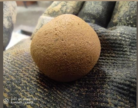
Ilustración 92. Ensayo de límite plástico. MUESTRA 3. Benalcázar, M., Zeas, V.,2020.
