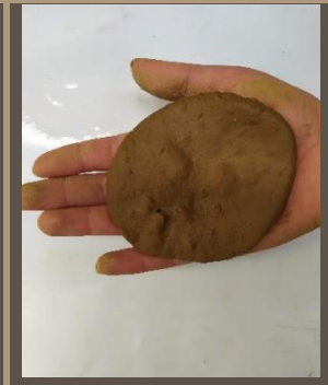
Ilustración 78. Test exudación de la tierra. MUESTRA 4. Benalcázar, M., Zeas, V., 2020.
