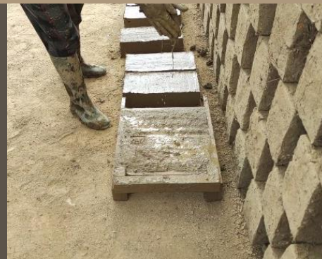
Ilustración 130. Moldeo del Adobe. PASO 4. Benalcázar, M., Zeas, V.,2020.
