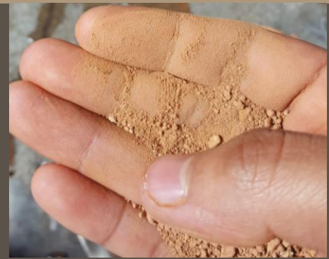
Ilustración 19. Test - Tacto de la tierra. MUESTRA 1 Benalcázar, M., Zeas, V.,2020.
