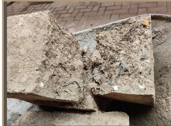
Ilustración 145. Soga en Adobe Tradicional de prueba. Benalcázar, M., Zeas, V., 2020.
