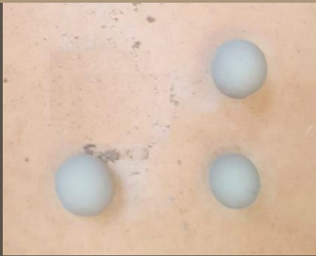
Ilustración 100. Muestras para ensayo para seleccionar la cal adecuada. Benalcázar, M., Zeas, V.,2020.
