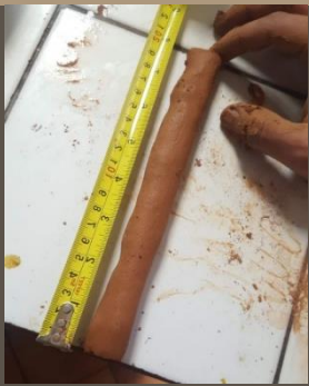
Ilustración 63. Test del rollo. MUESTRA 1. Benalcázar, M., Zeas, V., 2020.
