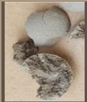
Ilustración 30. Test de brillo de la tierra. MUESTRA 2. Benalcázar, M., Zeas, V.,2020.
