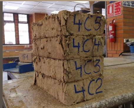
Ilustración 137. Adobes mejorados después del ensayo de Compresión. Tipo 4. Benalcázar, M., Zeas, V., 2020.
