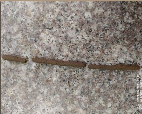
Ilustración 93. Ensayo de límite plástico. MUESTRA 4. Benalcázar, M., Zeas, V.,2020.
