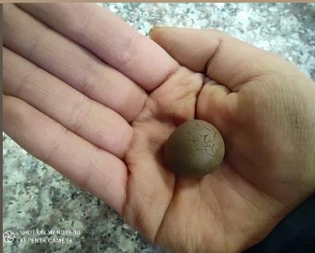
Ilustración 91. Ensayo de límite plástico. MUESTRA 4. Benalcázar, M., Zeas, V.,2020.
