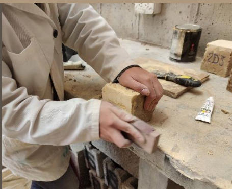
Ilustración 96. Rectificación de dados. Benalcázar, M., Zeas, V.,2020
