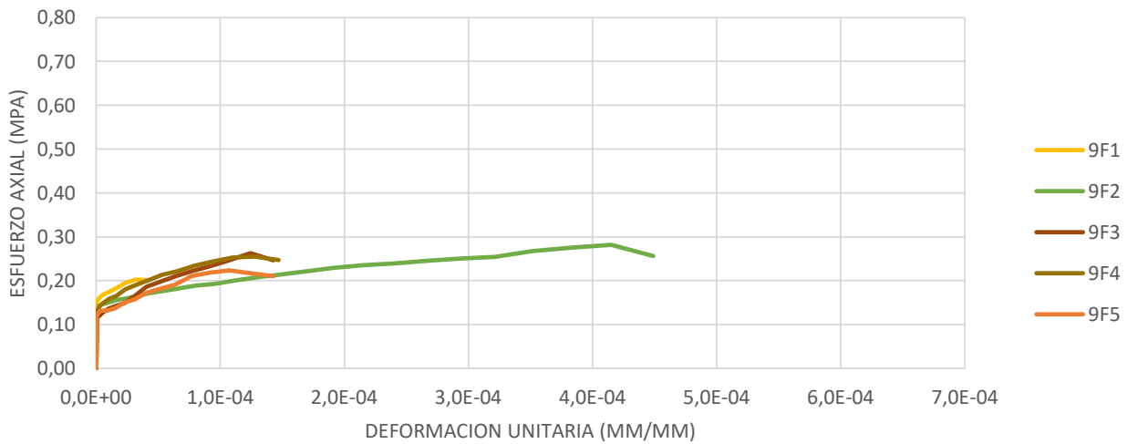
Gráfica 32. Diagrama Esfuerzo/Deformación Unitaria. Ensayo de Flexión. (ADOBE TRADICIONAL). Benalcázar, M., Zeas, V., 2021
