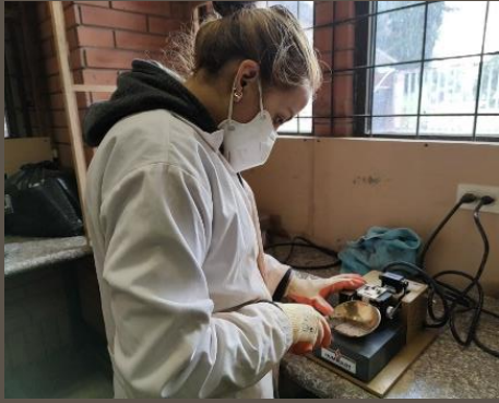
Ilustración 87. Ensayo de límite líquido. MUESTRA 4. Benalcázar, M., Zeas, V.,2020.
