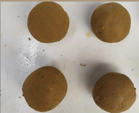
Ilustración 42. Test de resistencia Seca. MUESTRA 4. Benalcázar, M., Zeas, V., 2020.
