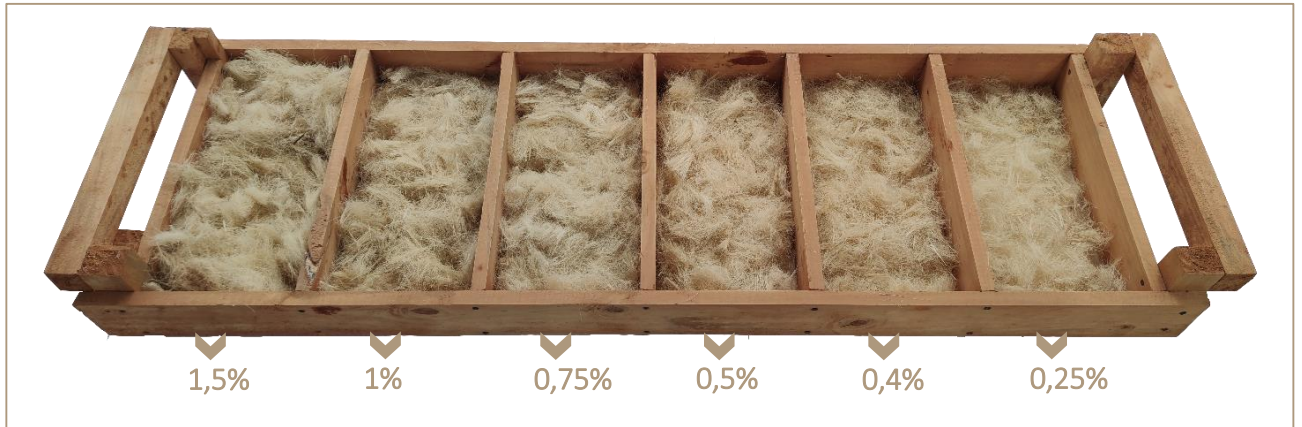
Ilustración 112. Ensayo de cantidad de cabuya. Benalcázar, M., Zeas, V., 2020.
