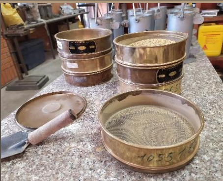
Ilustración 81. Ensayo de granulometría. Pesaje de masa retenida en cada tamiz. MUESTRA 3. Benalcázar, M., Zeas, V.,2020.
