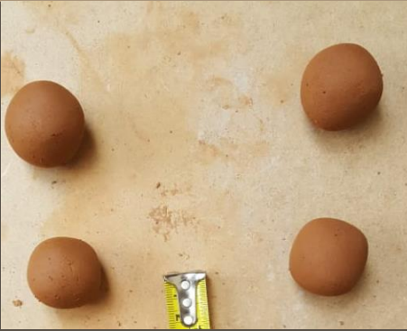
Ilustración 39. Test de resistencia Seca. MUESTRA 1. Benalcázar, M., Zeas, V., 2020.
