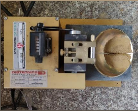
Ilustración 89. Ensayo de límite líquido. MUESTRA 4. Benalcázar, M., Zeas, V.,2020.
