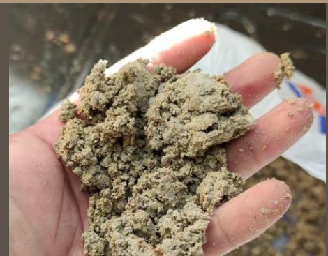
Ilustración 20, Test - Tacto de la tierra. MUESTRA 2. Benalcázar, M., Zeas, V.,2020.
