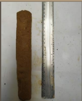
Ilustración 69. Test del rollo. MUESTRA 4. Benalcázar, M., Zeas, V., 2020.
