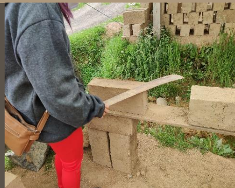
Ilustración 135. Proceso de secado de los adobes. Alizado. Benalcázar, M., Zeas, V., 2020.
