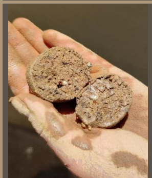
Ilustración 34. Test de brillo de la tierra. MUESTRA 4. Benalcázar, M., Zeas, V.,2020.
