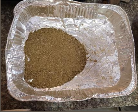
Ilustración 79. Ensayo de granulometría, proceso de Secado. MUESTRA 3. Benalcázar, M., Zeas, V.,2020.
