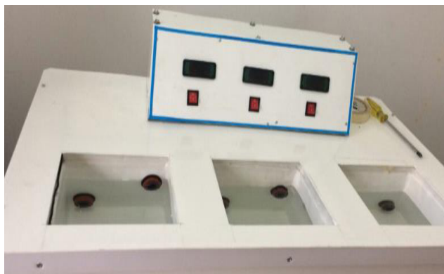
Gráfico 3. Compartimentos de la máquina de termociclado.
