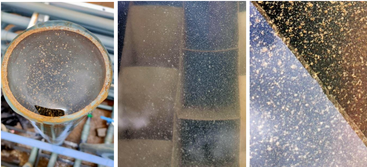
Figura 37. Control de formación de flocs en el FTV piloto y sedimentador.
