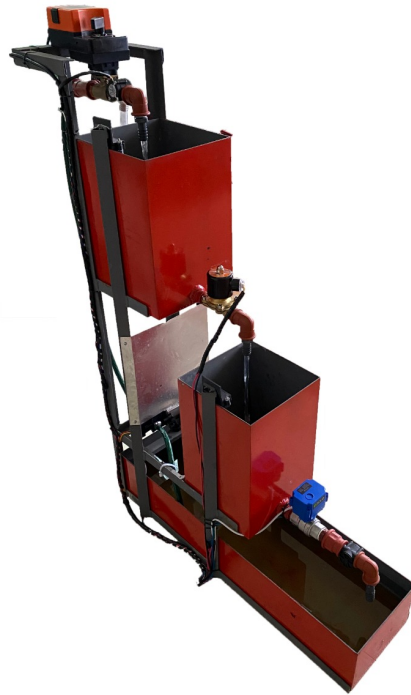
Figura 5.1: Sistema multi-tanque ensamblado.
