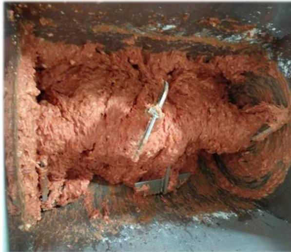
*Ilustración 6 Mezclado de materias primas, aditivos y especias*
