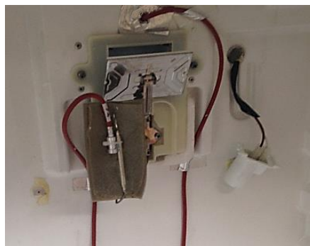
Figura 14. Montaje de termoresistores internos Fuente: Autores
