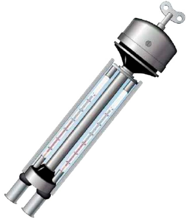
20 ILUSTRACIÓN DE UN PSICRÓMETRO DE ASSMANN
