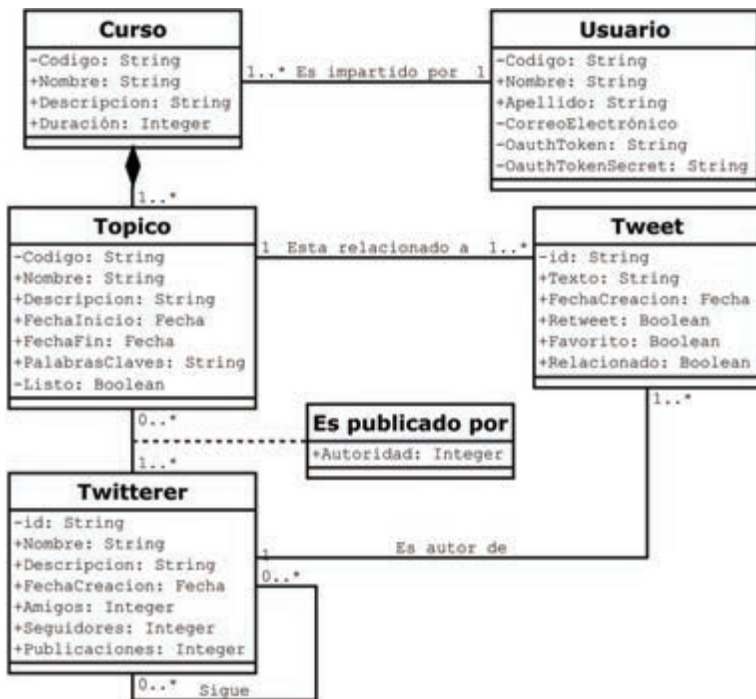
Figura 12.4 Diagrama de clases del sistema
