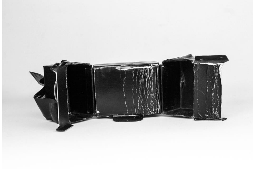
Foto. 31. Daño interno causado por presión del film. 73
