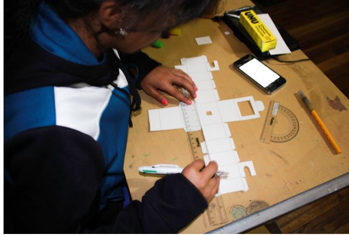
Foto. 48. Proceso de corte del contenedor 2 interno. 90
