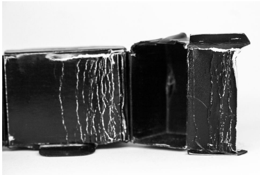
Foto. 32. Detalle daño interno causado por presión del film. 74
