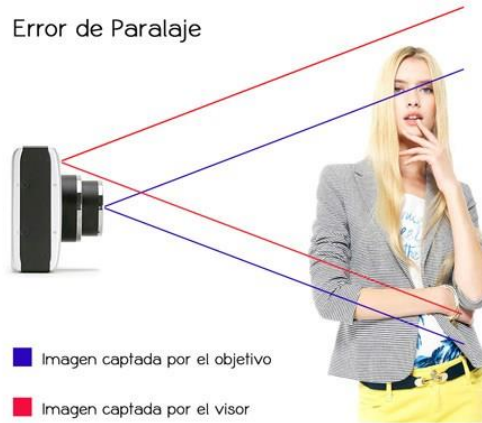
Foto. 8. Explicación gráfica de error de paralaje. 15
