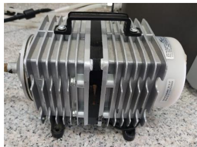
(b) Compresor de aire
