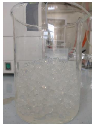
Figura 17. Perlas de alginato de sodio sin Chlorella.
