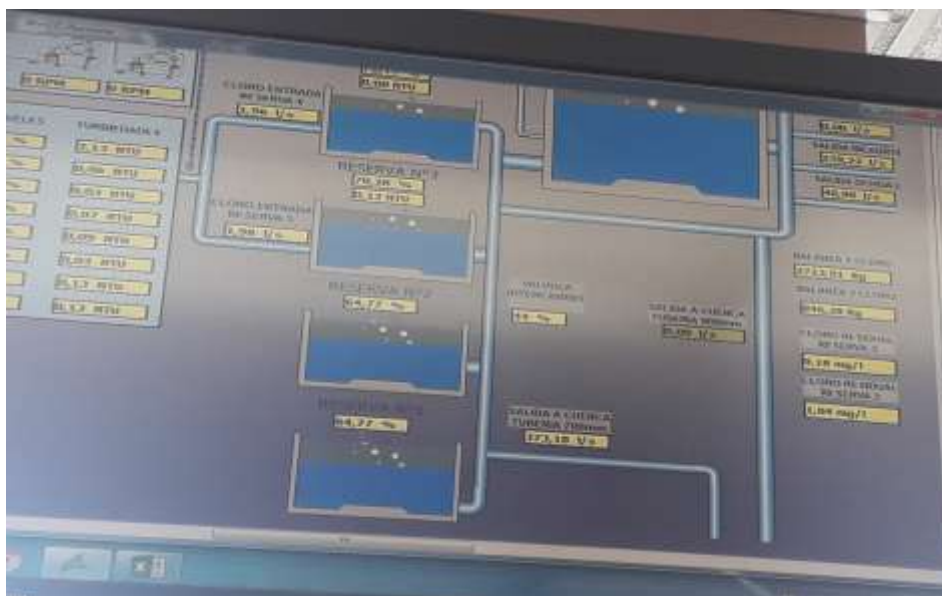
Figura 126. Sistema de Distribución desde el Sistema SCADA
