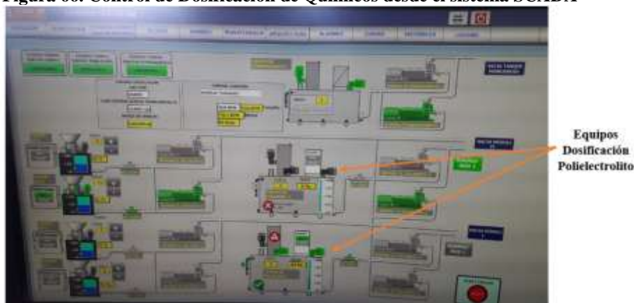
Figura 66. Control de Dosificación de Químicos desde el sistema SCADA
