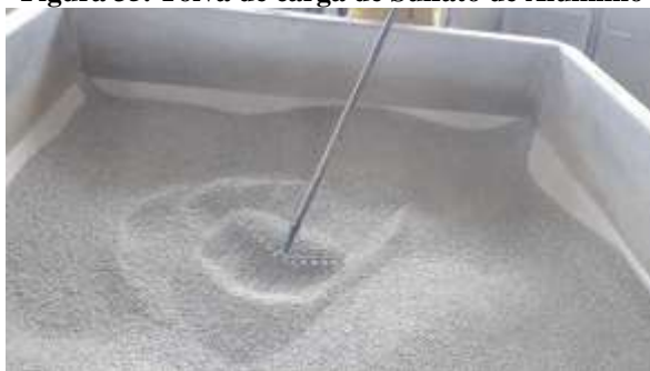
Figura 35. Tolva de carga de Sulfato de Aluminio
