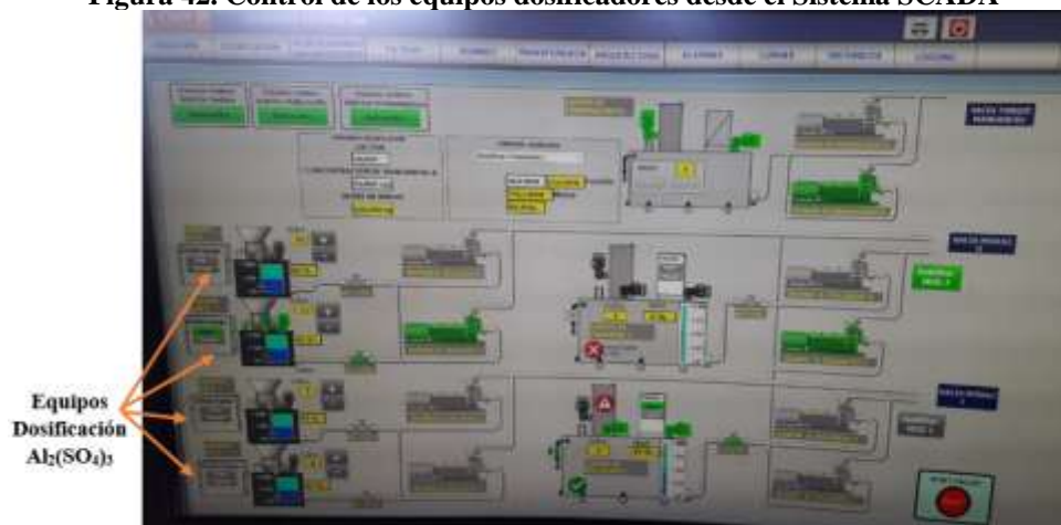
Figura 42. Control de los equipos dosificadores desde el Sistema SCADA
