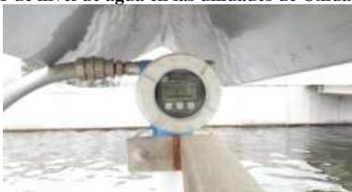
Figure 8. Sensor de nivel de agua en las unidades de Oxidación y Aireación
