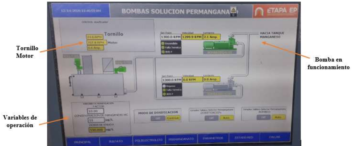
Figura 19. Panel de control en la opción PERMANGANATO
