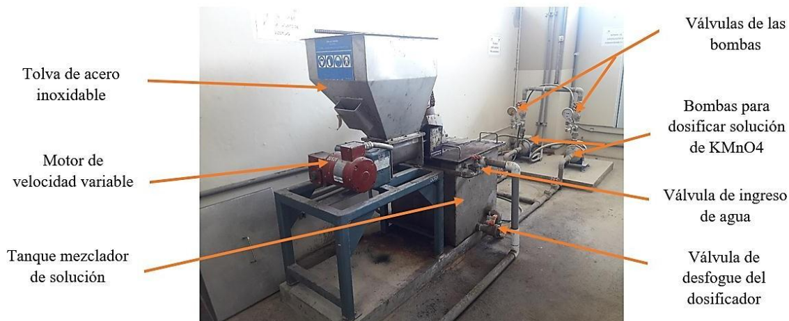
Figura 34. Dosificador volumétrico para productos químicos secos- Modelo W105
