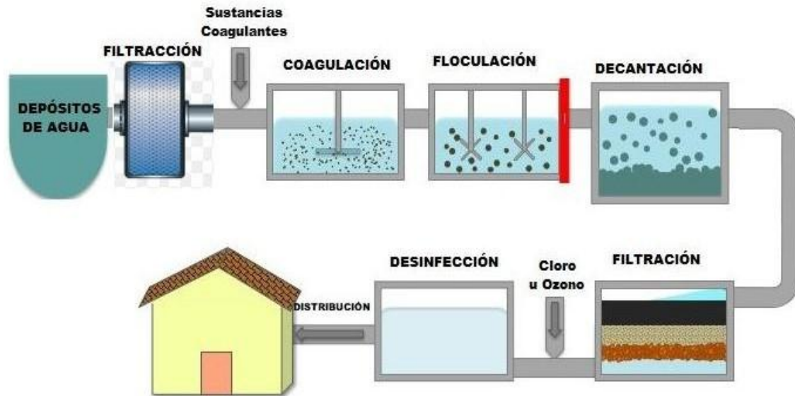
Figura 2. Esquema del proceso de potabilización del agua
