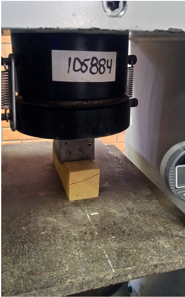
Foto: Ensayo perpendicular a la fibra
