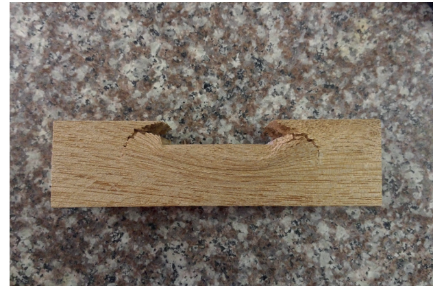
Foto: Ensayo perpendicular a la fibra
