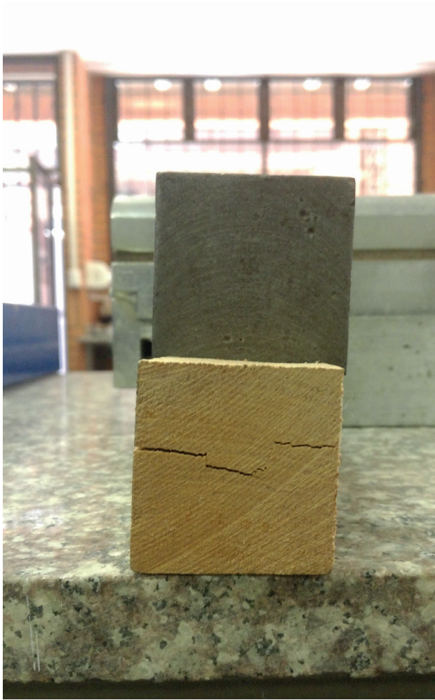
Foto: Ensayo perpendicular a la fibra
