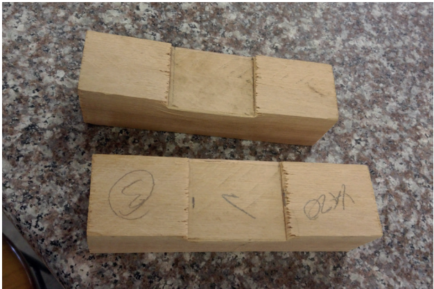
Foto: Ensayo perpendicular a la fibra
