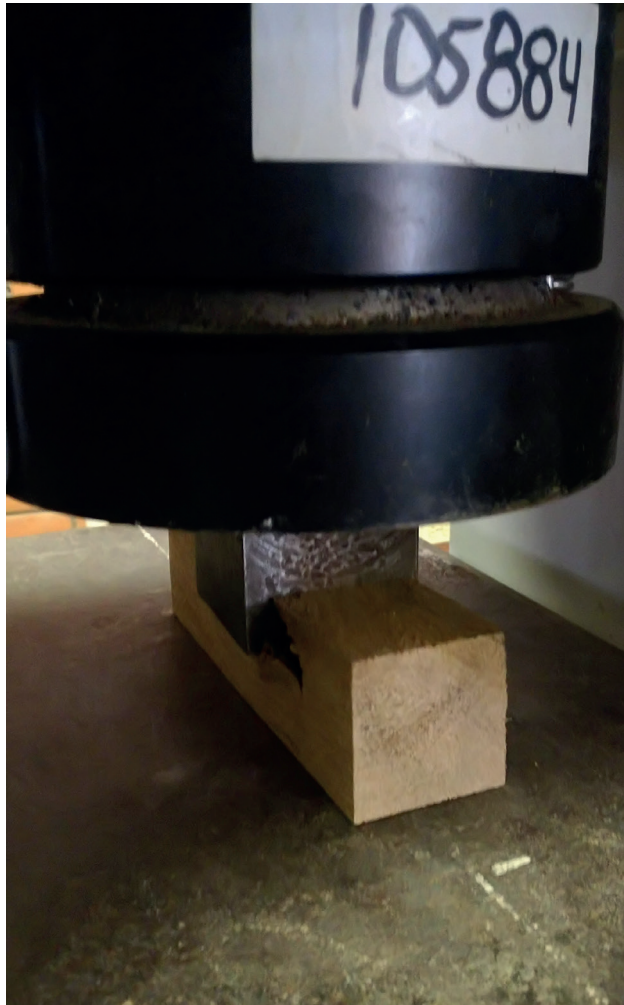
Foto: Ensayo perpendicular a la fibra
