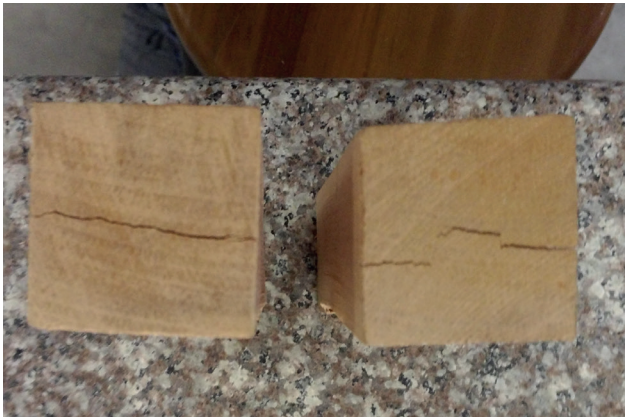
Foto: Ensayo perpendicular a la fibra
