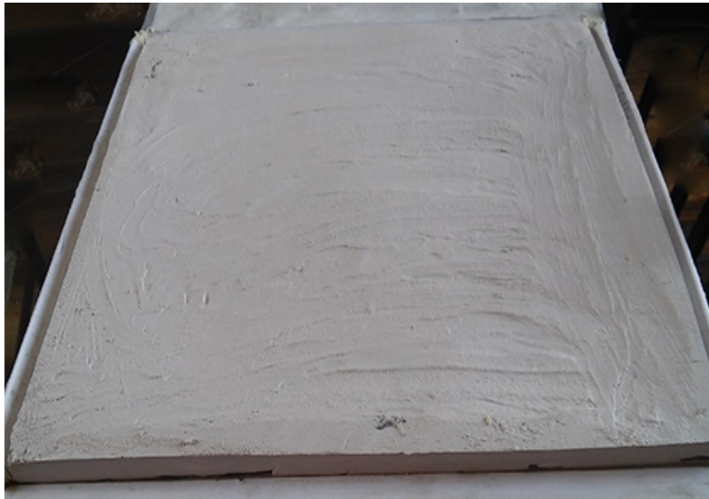
Imagen 4.29 Acabado de molde con yeso
