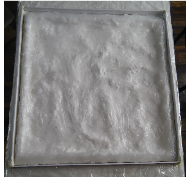
Imagen 4.28 Tercera capa de caucho
