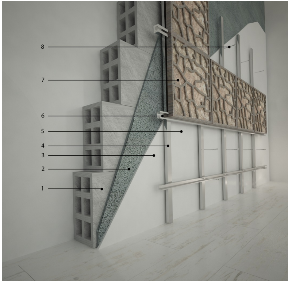
Imagen 5.04 instalación mediante perfilera
