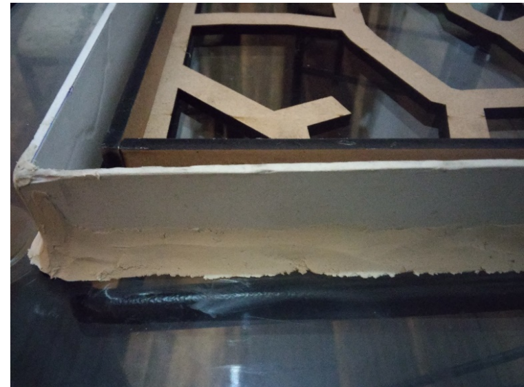
Imagen 4.26 Armado y sellado de cajón para molde
