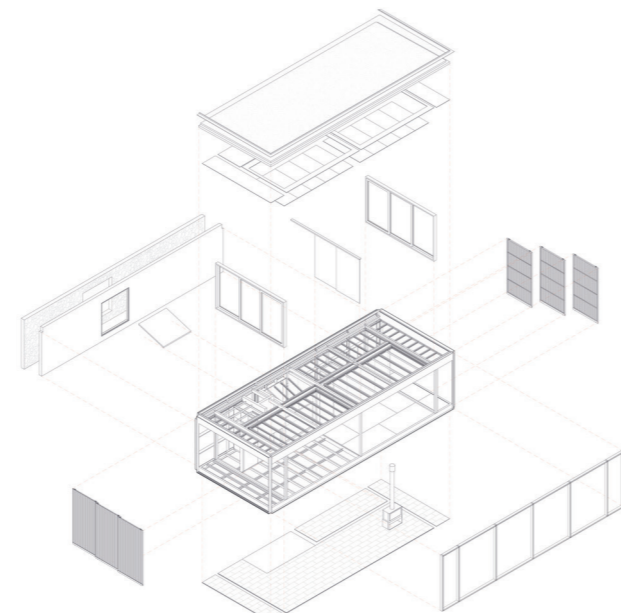
Axonometría explotada sistema constructivo cabaña
