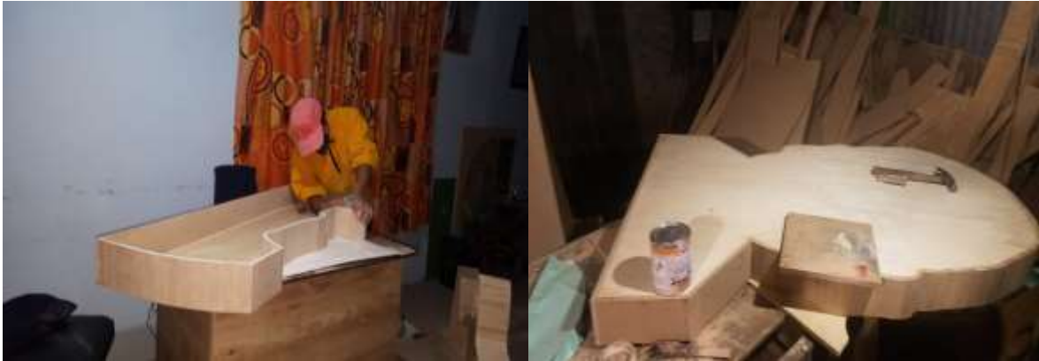
Ilustración 29 Empore y lijado de aberturas para tener una superficie pulida lista para pintar, Cochancela, J. (2021) [Fotografía], Registro del autor.
