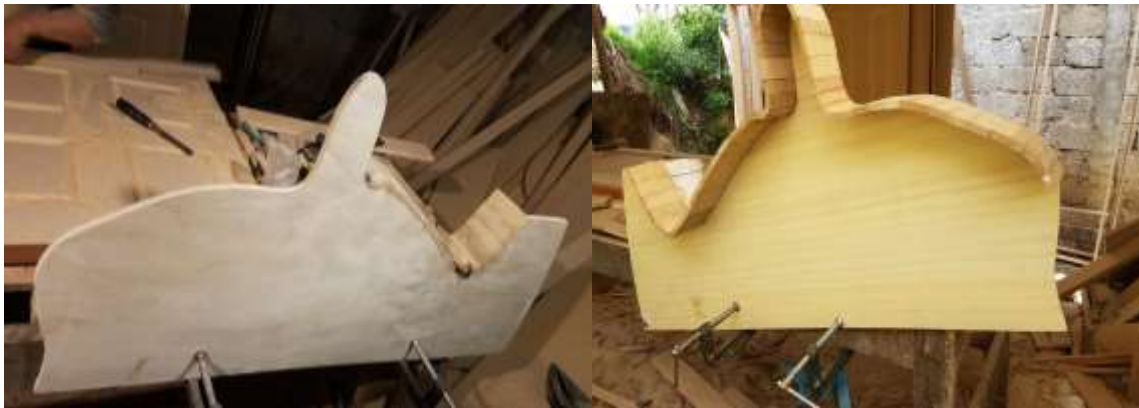
Ilustración 28 Ensamblaje del contorno de la base con pedazos de madera dando forma a la silueta de los personajes, Cochancela, J. (2021) [Fotografía], Registro del autor.
