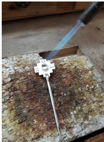
Fotografía 27. Piedra pómez. Proceso de soldado de un tupu.
