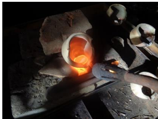
Fotografía 18. Soplete. Proceso de fundición con el soplete. Taller de Antonio Japón
