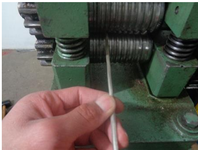
Fotografía 52. Proceso de laminado en hilo
