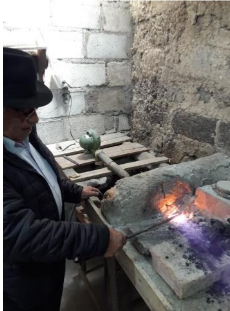
Fotografía 50. Recocido de una lámina en carbón. Taller de Luis Silva
