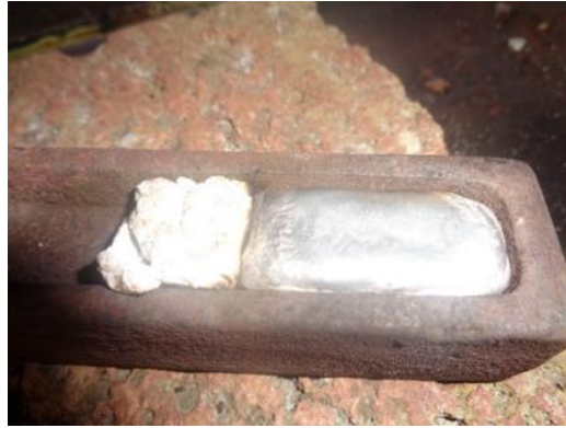
Fotografía 26. Rillera. Sobre ella está la plata fundida en forma de chapa.
