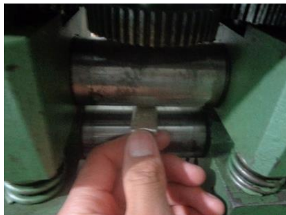
Fotografía 51. Proceso de laminado en chapa. Pasan por el rodillo de la laminadora.
