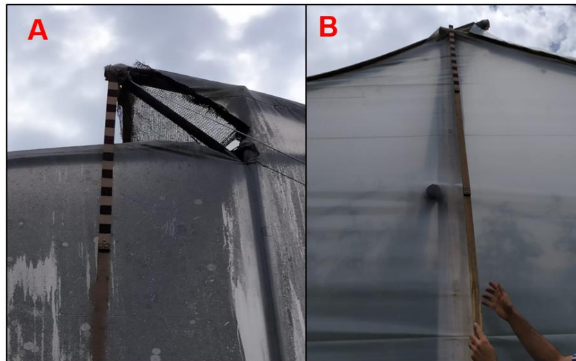
Medición de invernaderos. 26A: medición de la abertura de la cenital con un metro plegable de madera. 26B: medición de la altura del invernadero con un metro plegable de madera
