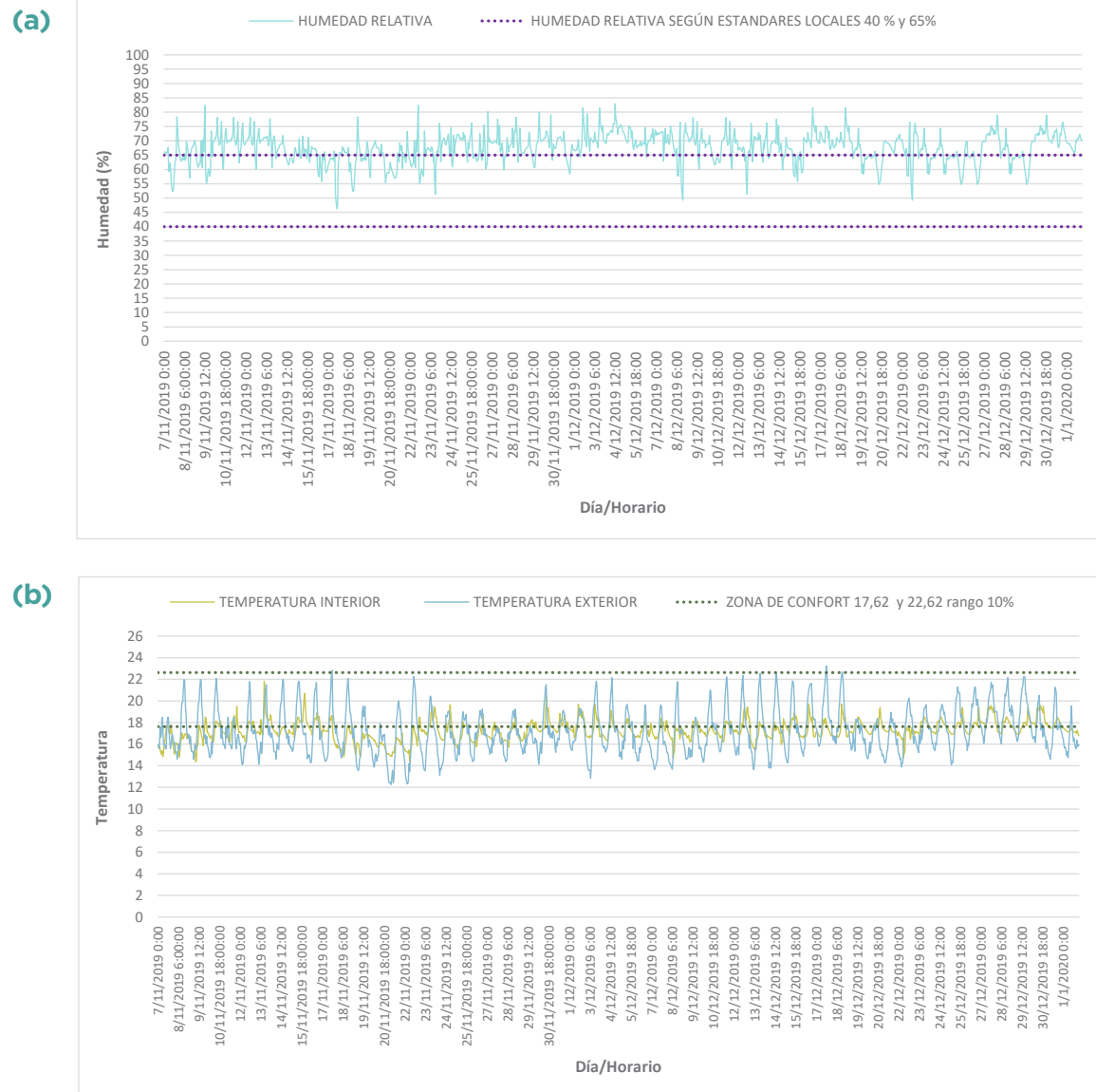
Figura 2.20 Monitorizaciones del ambiente interior departamento 5, a)Humedad b)Temperatura. Elaboración y fuente: Grupo de tesis.
