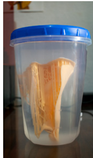
Figura 60. Aplicación de curado en agua. Recuperado de fuente propia.
