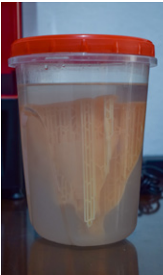
Figura 59. Aplicación de curado en alcohol. Recuperado de fuente propia.
