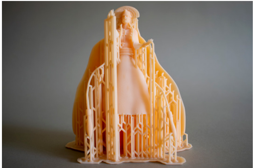
Figura 61. Secado con luz uv natural. Recuperado de fuente propia.
