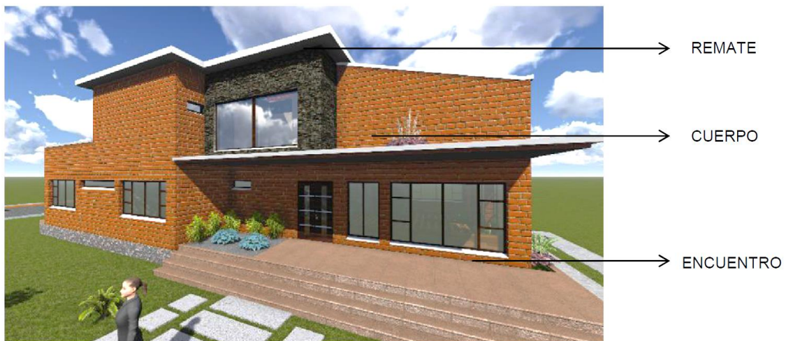
Fig. 15. Partes de la edificación. Elaboración propia
