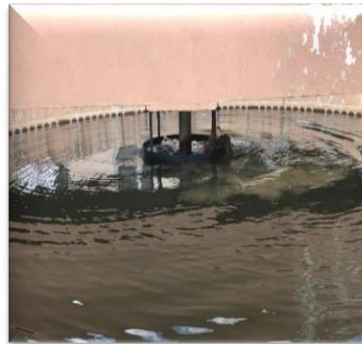
Ilustración 32 Agitador del espesador tipo hélice.
