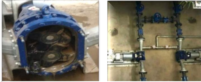
Ilustración 36. Mantenimiento bomba de lóbulos.
