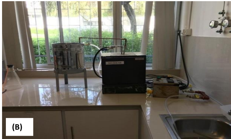
Figura 8. Esquema del Sistema Usado Para la Gasificación (A), y montaje en el laboratorio (B).
