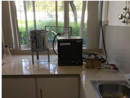
ilustración anexo 2. Sistema de gasificación armado
