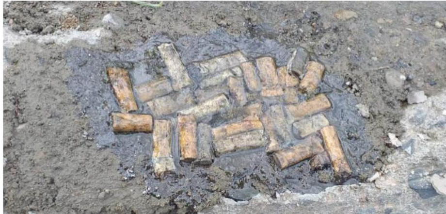
Ilustración 44, prueba 1: aplicación de la segunda capa de resina en la superficie.
