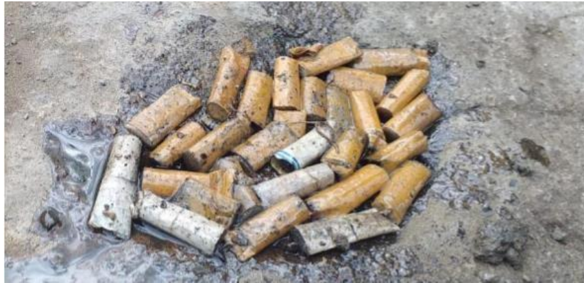
Ilustración 42, prueba 1. Aplicación de la resina poliéster sobre las colillas de tabaco.
