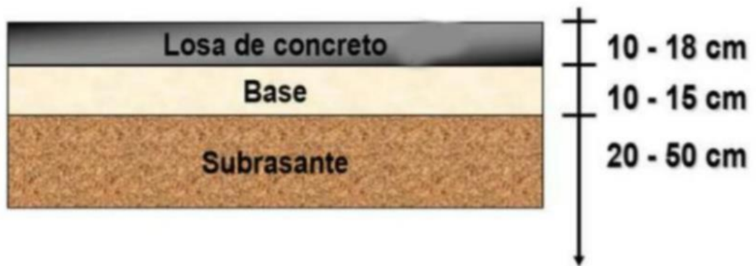
Ilustración 21, espesor del pavimento rígido.
