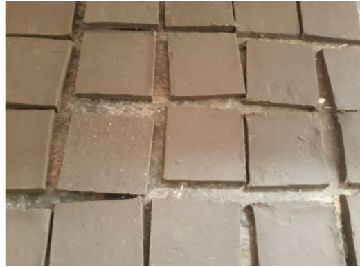
Ilustración 36, proceso de creación de las baldosas. Dimensiones: 4cm x 4cm.
