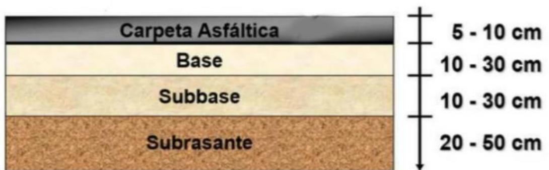
Ilustración 23, espesor del pavimento flexible.
