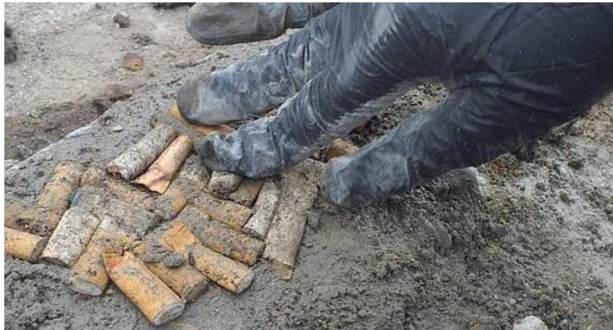
Ilustración 41, prueba 1: posición de las colillas de tabaco sobre la grieta usando materiales diversos.
