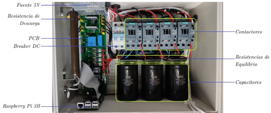
Figura 3.26. Trazador de curvas I-V construido. Parte Interior.
