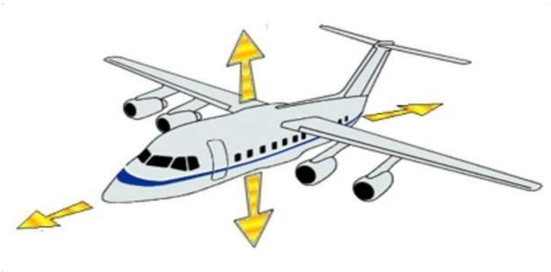
Curriculum Nacional. Diagrama de fuerzas en un avión en vuelo. [Figura]. Recuperado de: https://www.curriculumnacional.cl/614/w3-article-23104.html
