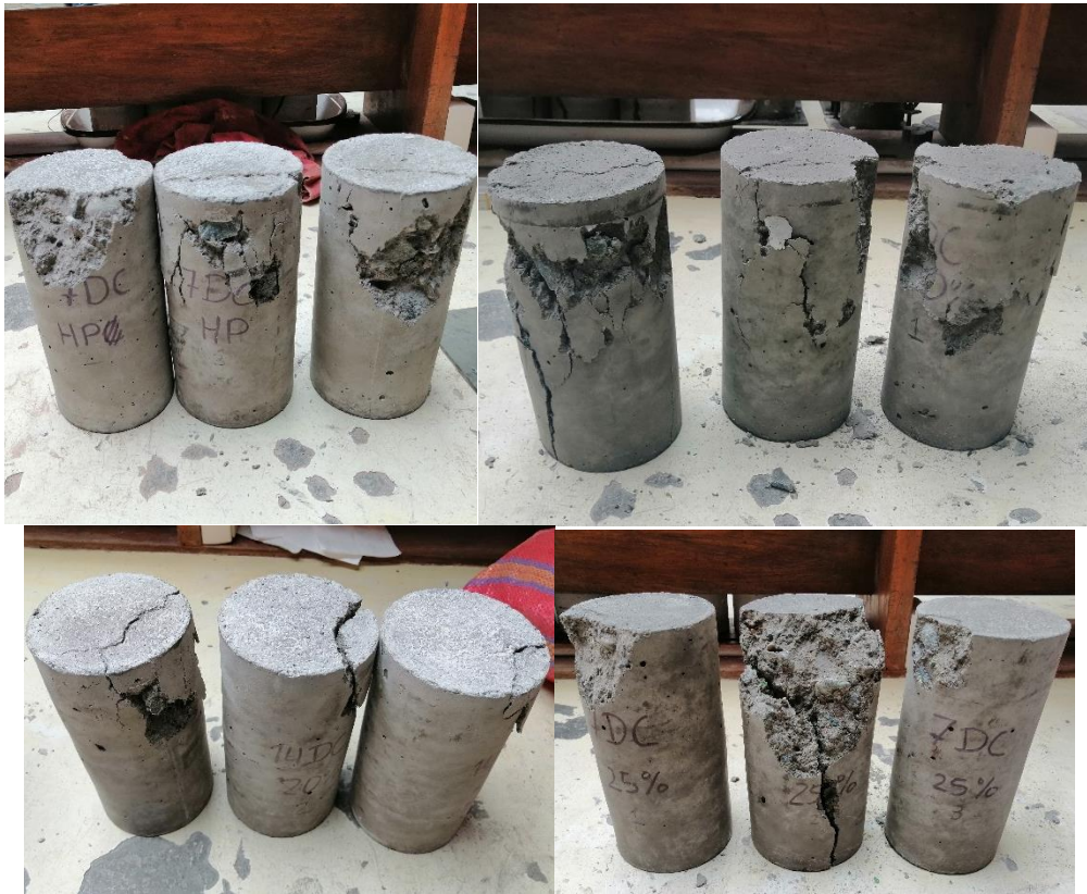
Ilustración 21: Tipos de fallas en las probetas ensayadas a Compresión (fuente propia).
