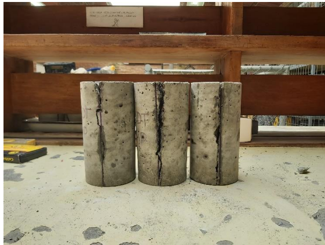
Ilustración 17: Especímenes ensayados a tracción indirecta (fuente propia).
