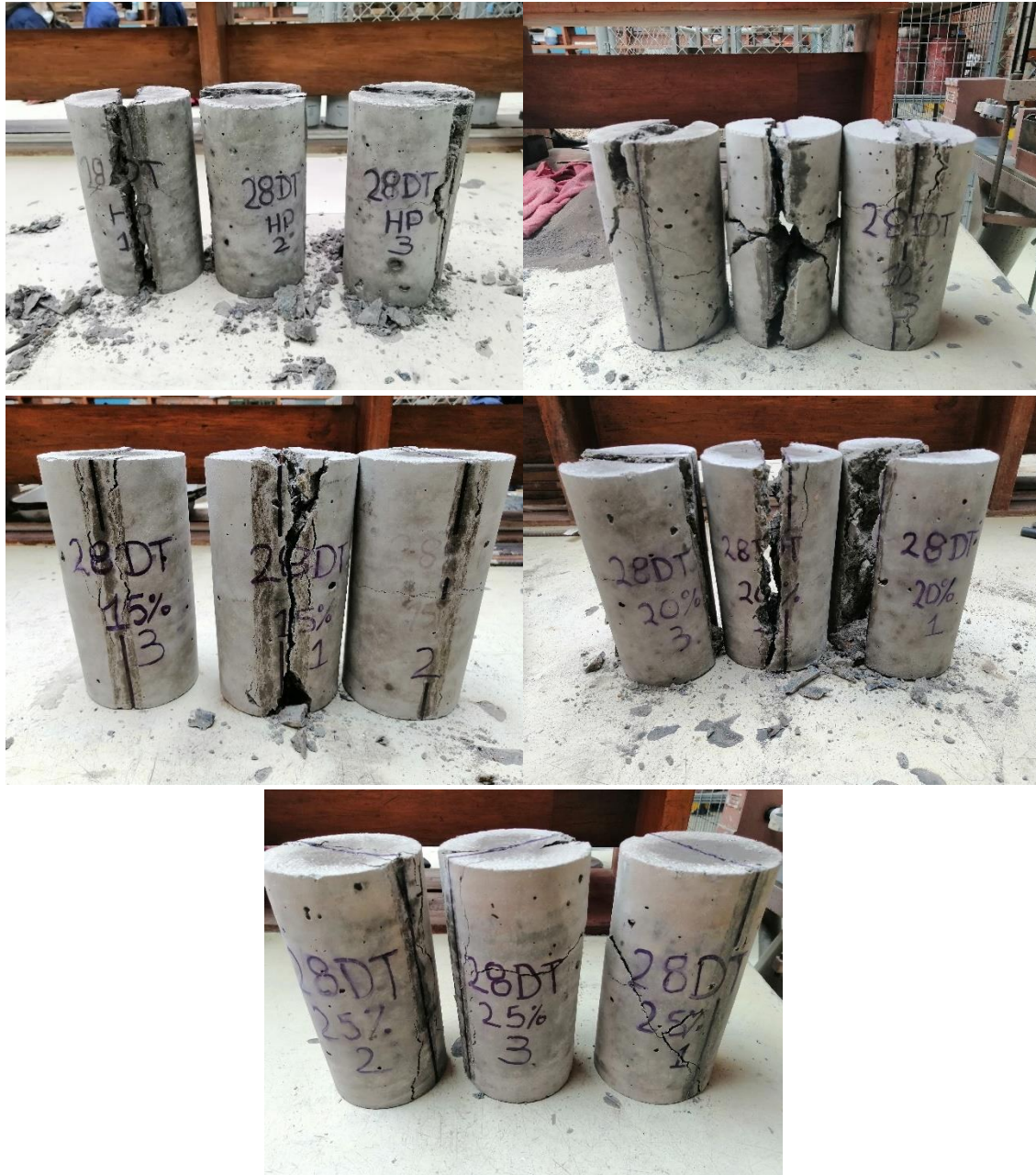
Ilustración 47: Elementos de hormigón de distintas mezclas ensayados a los 28 días para tracción.
