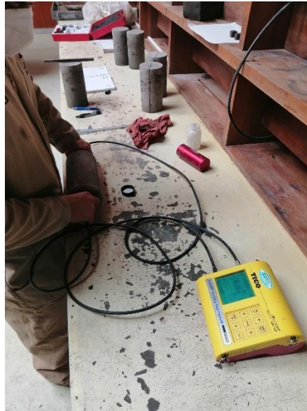
Ilustración 18: Ensayo de ultrasonido en especímenes (fuente propia).
