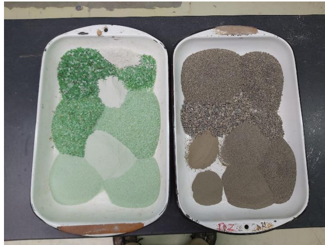
Ilustración 8: Granulometría del árido fino replicada con agregado reciclado (fuente propia).
