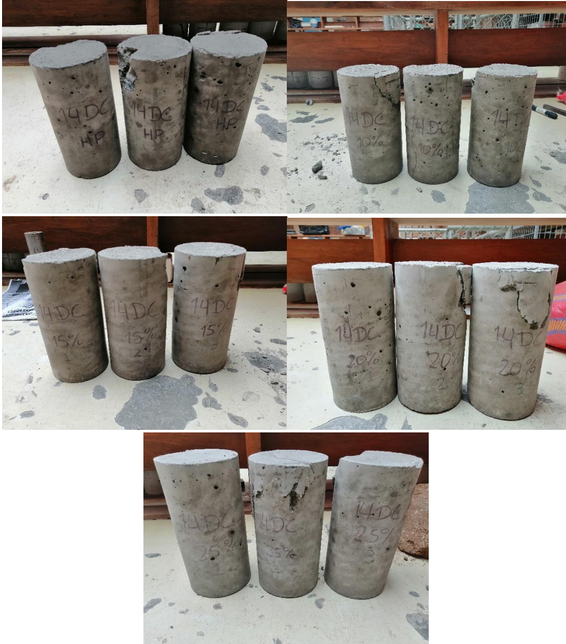
Ilustración 43: Elementos de hormigón de distintas mezclas ensayados a los 14 días para compresión.
