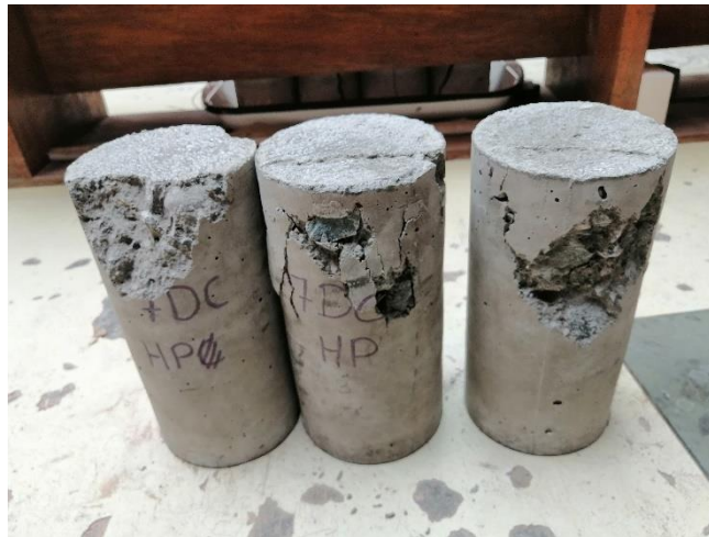
Ilustración 15: Especímenes ensayados a compresión (fuente propia).
