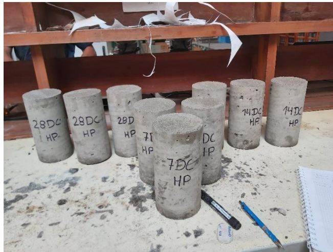
Ilustración 13: Rotulado de probetas a compresión de hormigón patrón (fuente propia).
