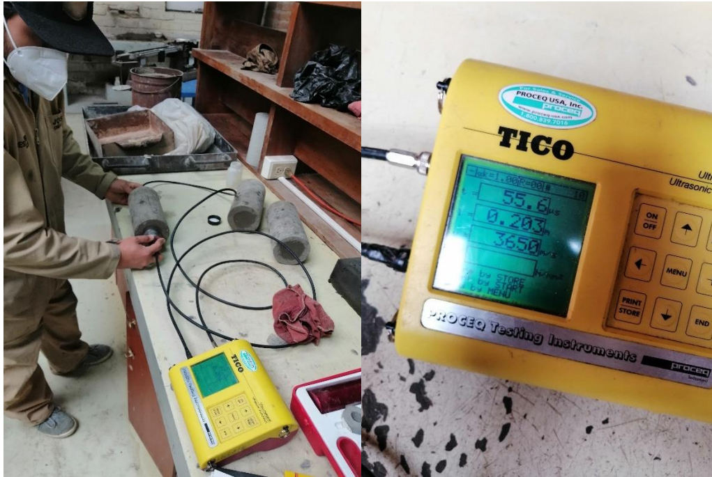
Ilustración 24: Análisis de una probeta mediante el ensayo de ultrasonido (fuente propia).
