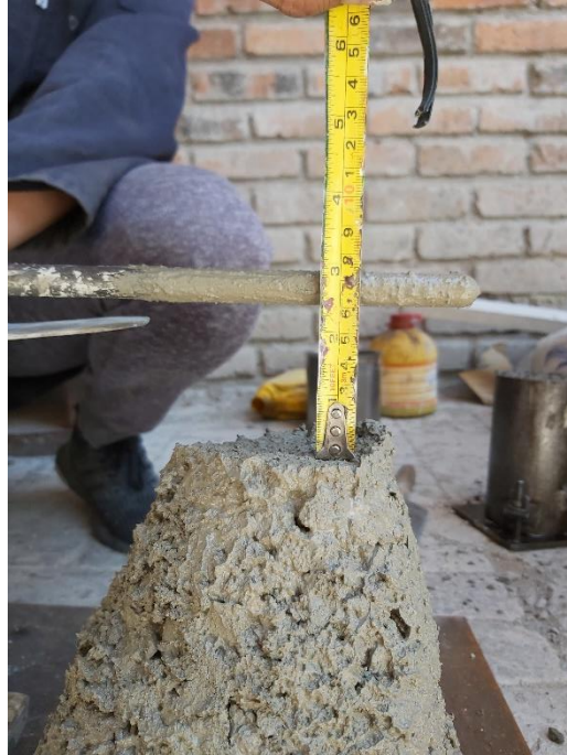
Ilustración 10: Resultado de primera prueba con el cono de Abrams (fuente propia).
