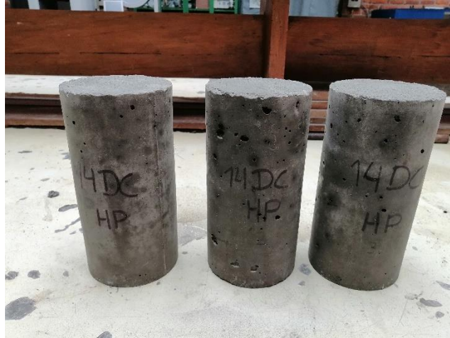
Ilustración 20: Muestras de una misma mezcla para un día específico de curado (fuente propia).
