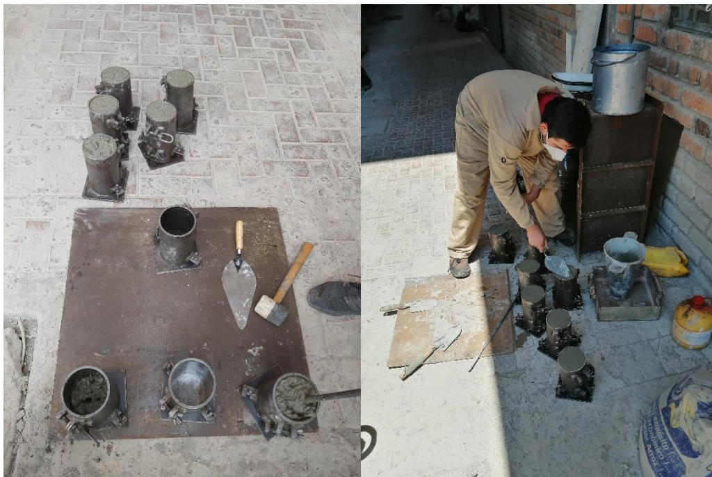
Ilustración 11: Vertido de la mezcla de hormigón en moldes (fuente propia).
