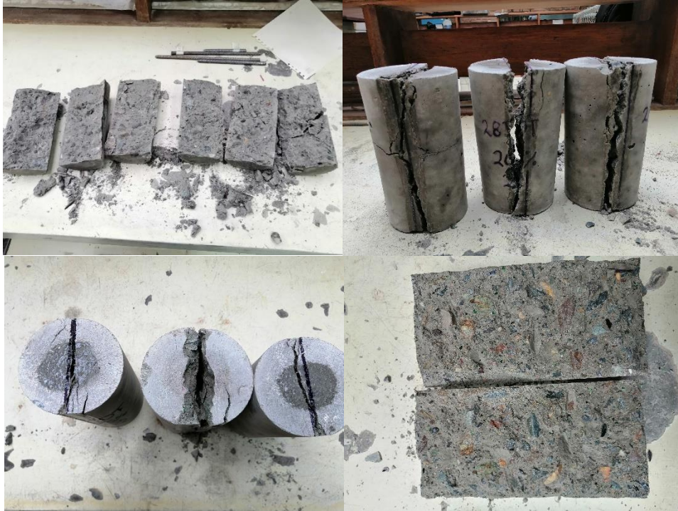
Ilustración 23: Planos de falla en las probetas ensayadas a tracción indirecta (fuente propia).
