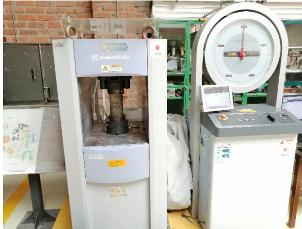
Ilustración 14: Especimen y prensa usada en el ensayo de compresión (fuente propia).
