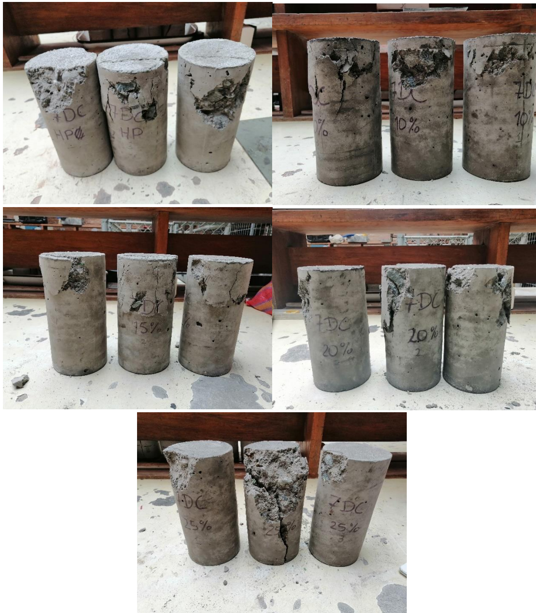
Ilustración 42: Elementos de hormigón de distintas mezclas ensayados a los 7 días para compresión.
