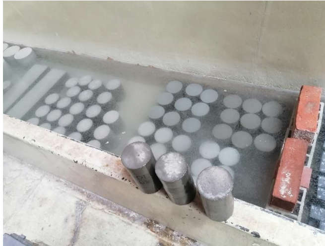
Ilustración 12: Probetas en la piscina de curado del laboratorio de la Universidad de Cuenca (fuente propia).
