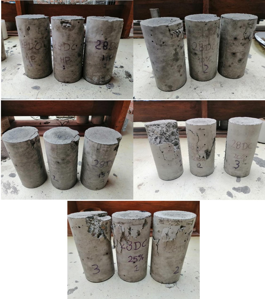
Ilustración 44: Elementos de hormigón de distintas mezclas ensayados a los 28 días para compresión.
