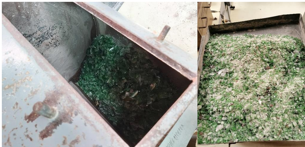
Ilustración 4: Trituración del agregado reciclado (fuente propia).
