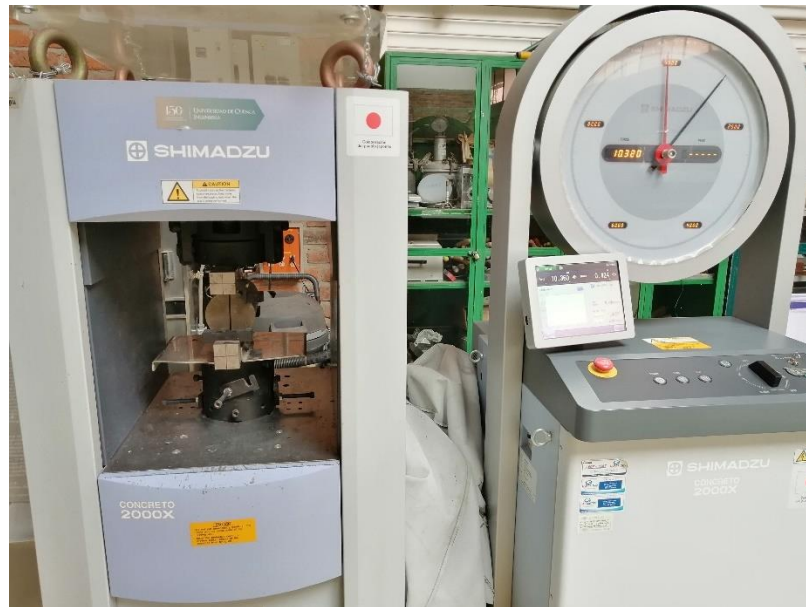
Ilustración 22: Ensayo de tracción indirecta (fuente propia).
