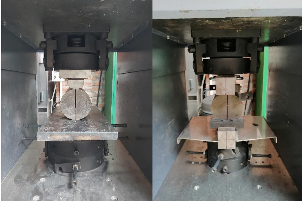
Ilustración 16: Especímenes colocados en la prensa antes de iniciar el ensayo de tracción indirecta (fuente propia).
