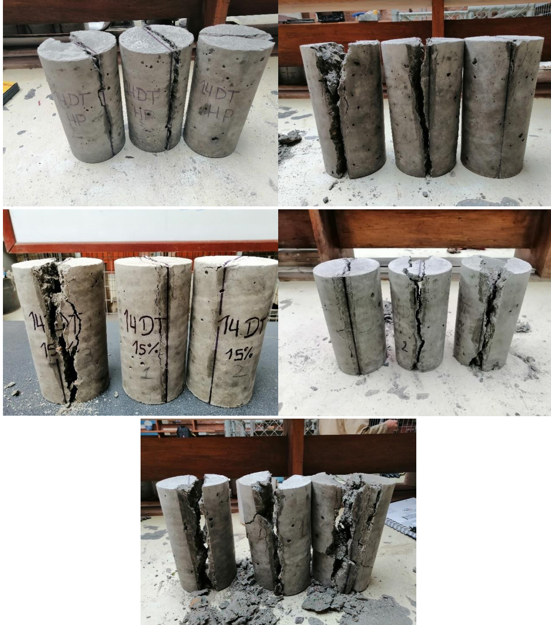
Ilustración 46: Elementos de hormigón de distintas mezclas ensayados a los 14 días para tracción.
