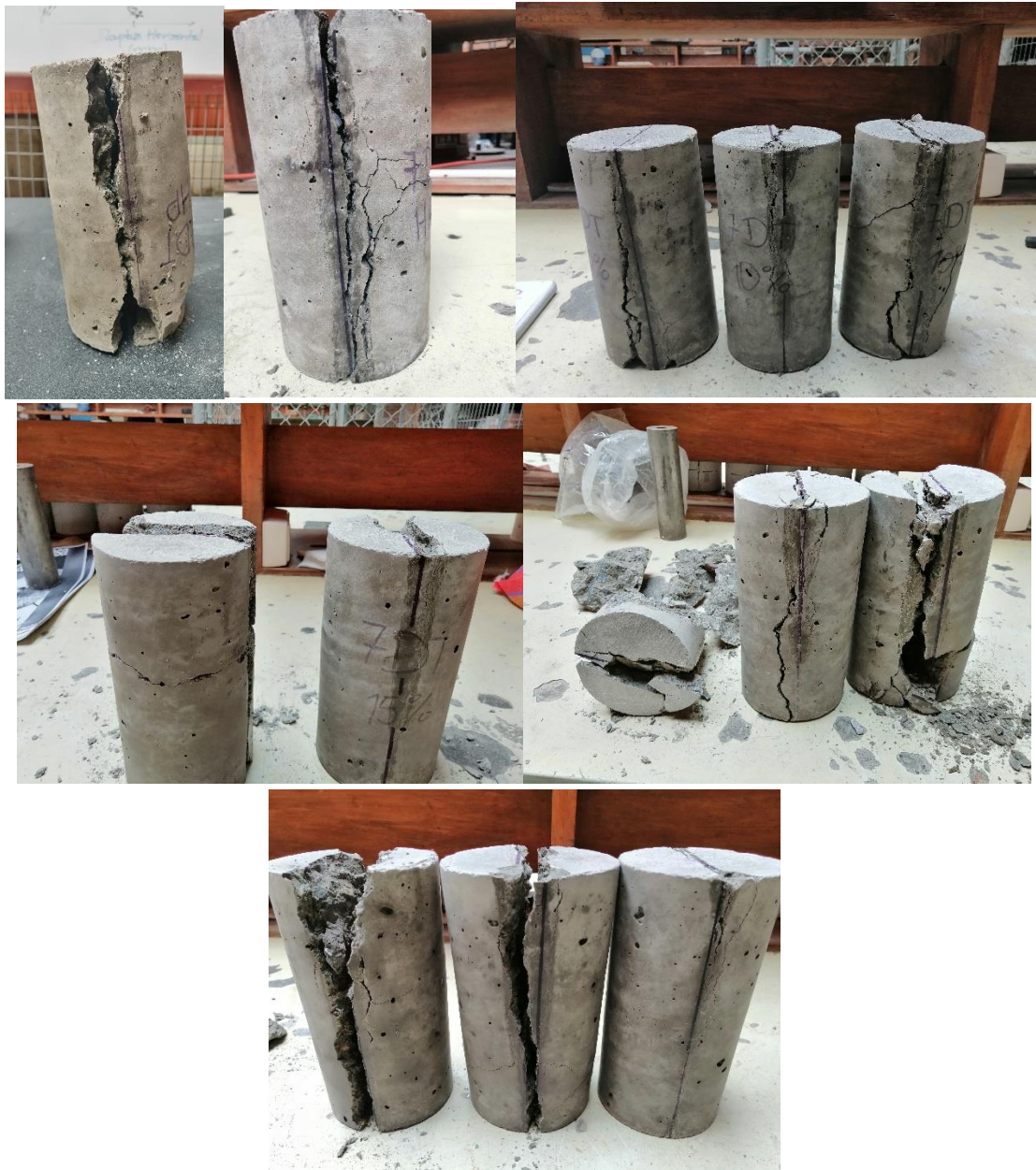
Ilustración 45: Elementos de hormigón de distintas mezclas ensayados a los 7 días para tracción.
