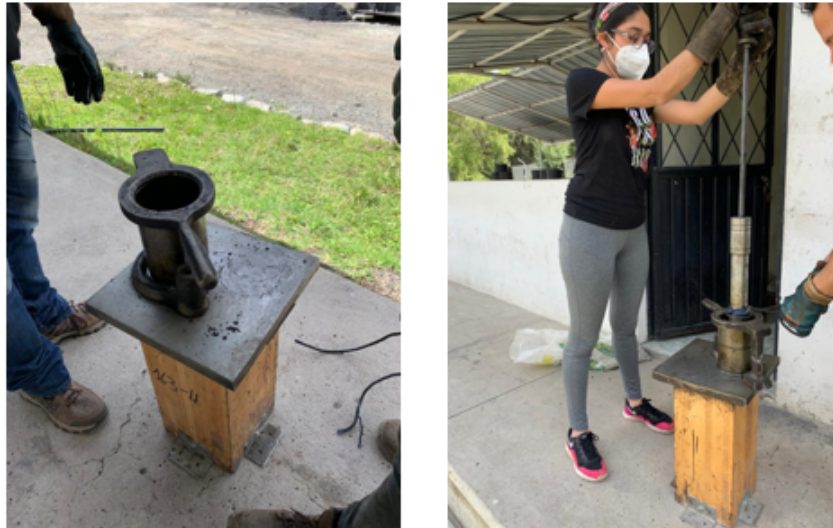
Figura 3.21: Compactación de la mezcla en el molde.
