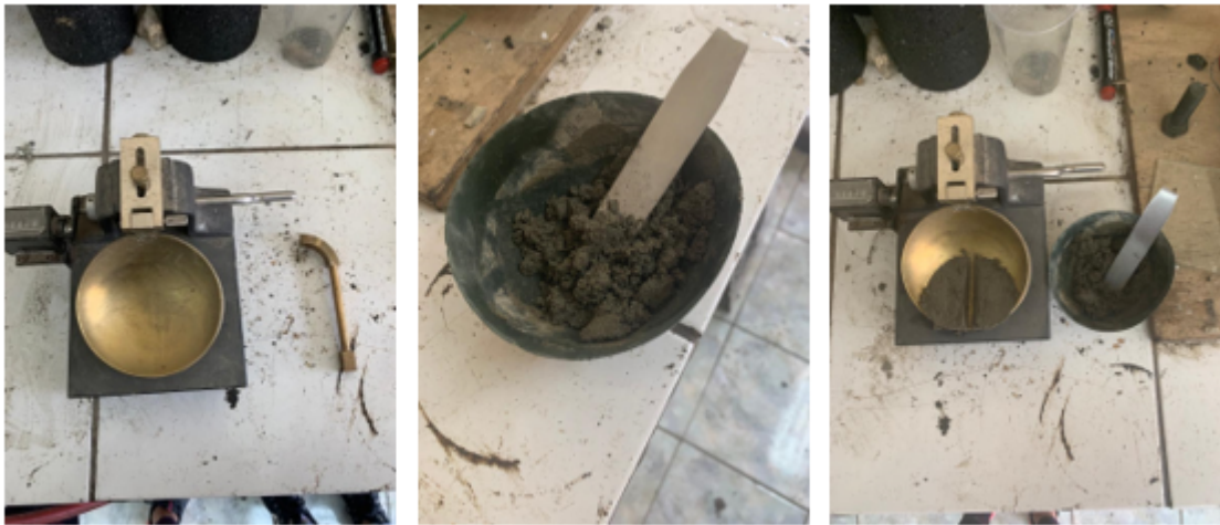
Figura 3.12: Límite líquido en agregado fino.
