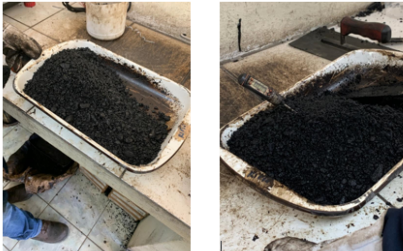
Figura 3.19: Mezcla de Áridos y Asfalto para la elaboración de las Brietas.
