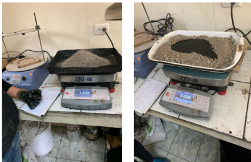
Figura 3.18: Preparación de áridos y asfalto para la elaboración de las briquetas.
