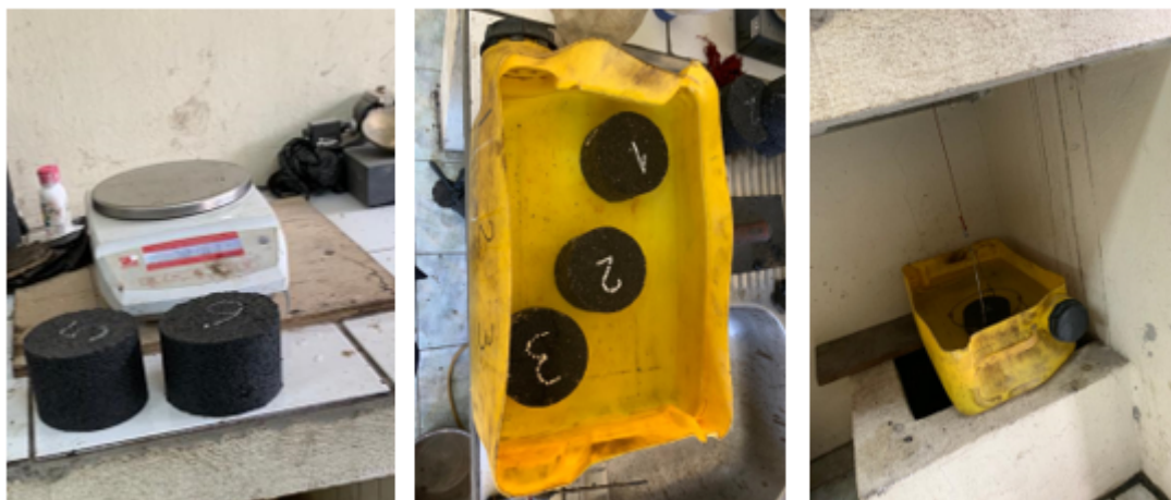
Figura 3.22: Determinación del peso específico bulk en briquetas.
