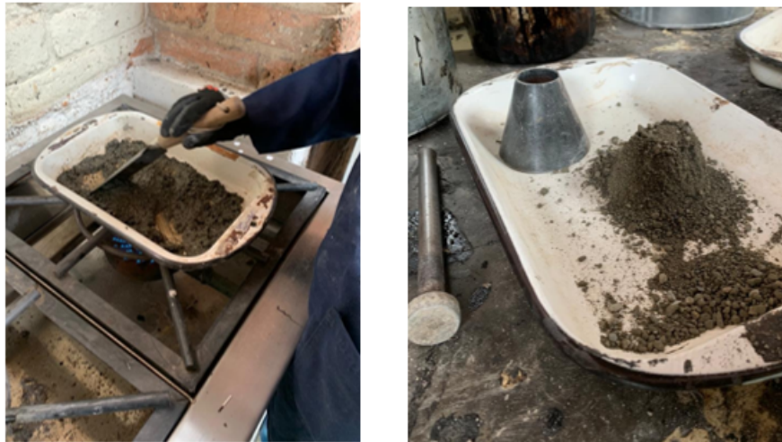
Figura 3.11: Condición saturada superficialmente seca del agregado fino.
