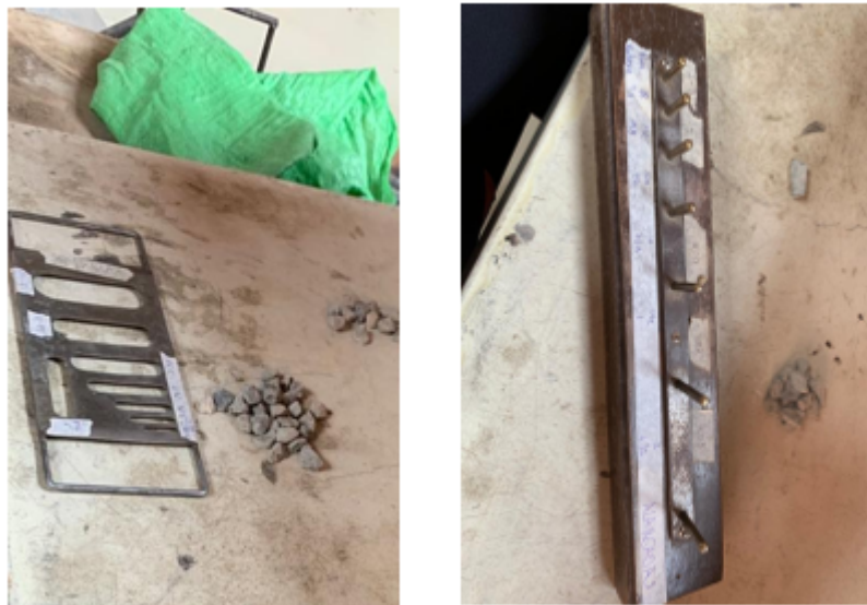
Figura 3.6: Ensayo de partículas chatas y alargadas.
