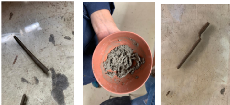
Figura 3.13: Límite plástico en el agregado fino.
