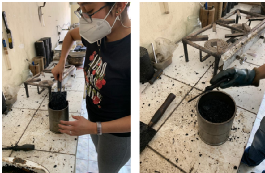
Figura 3.20: Colocación de la mezcla en el molde.
