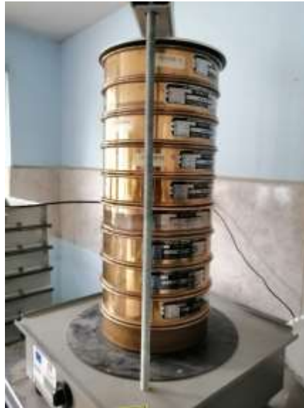
Ilustración 6: Serie de tamices para árido fino.
