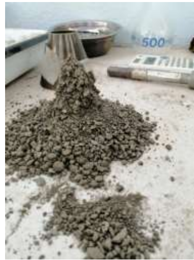
Ilustración 13: Verificación del estado SSS.
