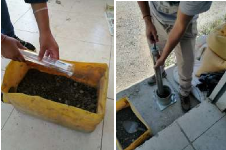
Ilustración 15: Preparación del material para ensayo de Proctor modificado.
