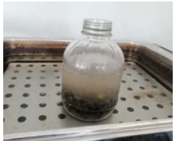
Ilustración 11: Picnómetro en baño maría.
