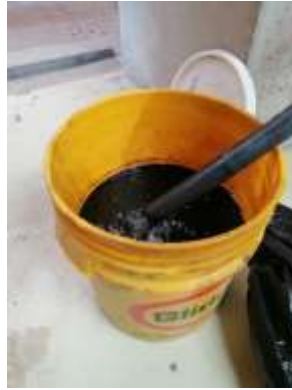
Ilustración 18: Balde para recoger la gasolina residual de extracción.
