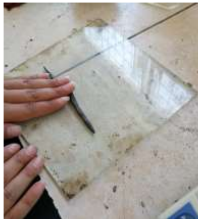
Ilustración 9: Formación de cilindros para límite plástico.
