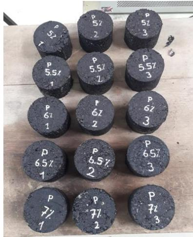
Figura 60. Briquetas patrón antes de ser ensayadas.
