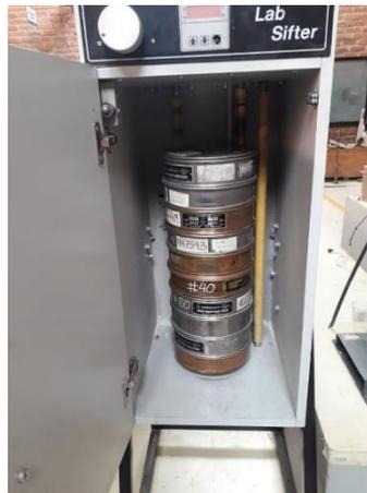
Figura 13. Análisis Granulométrico, Tamices finos.
