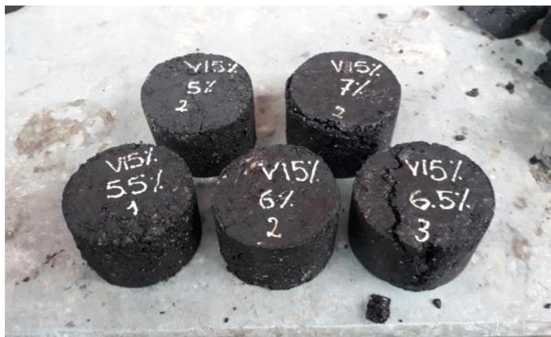
Figura 43. Briquetas luego del ensayo.
