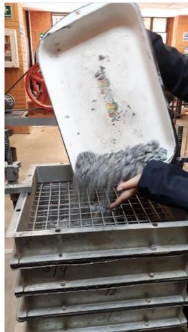
Figura 15. Tamizado del agregado grueso.
