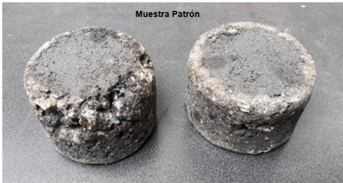
*Figura 103. Muestra Patrón luego del ensayo de abrasión.*
