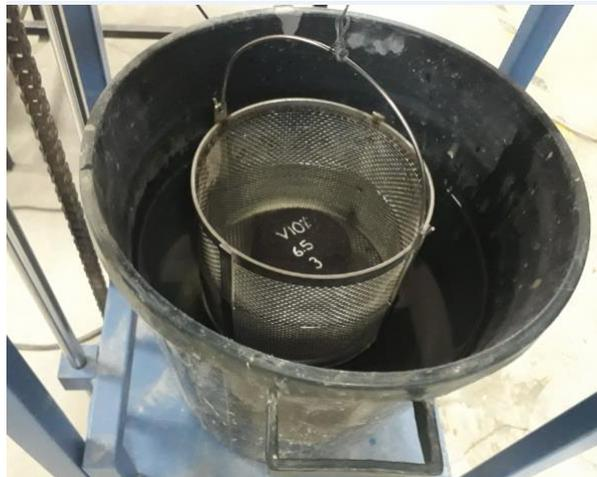
Figura 39. Briqueta sumergida en agua a 25°C.
