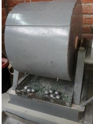
*Figura 26. Colocación del material dentro de la Máquina de los Ángeles.*
