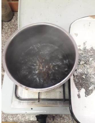
Figura 49. Mezcla de agregado cubierto con asfalto en agua hirviendo.
