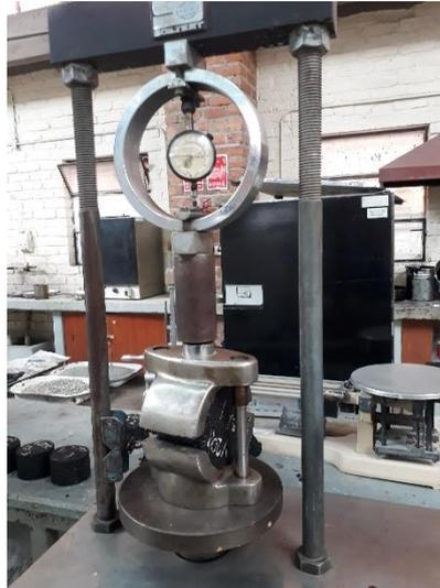
Figura 42. Ejecución del ensayo Marshall.
