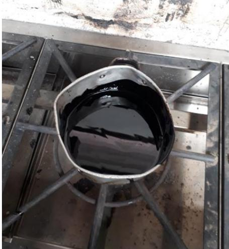
Figura 33. Betún asfáltico calentado en la cocina.
