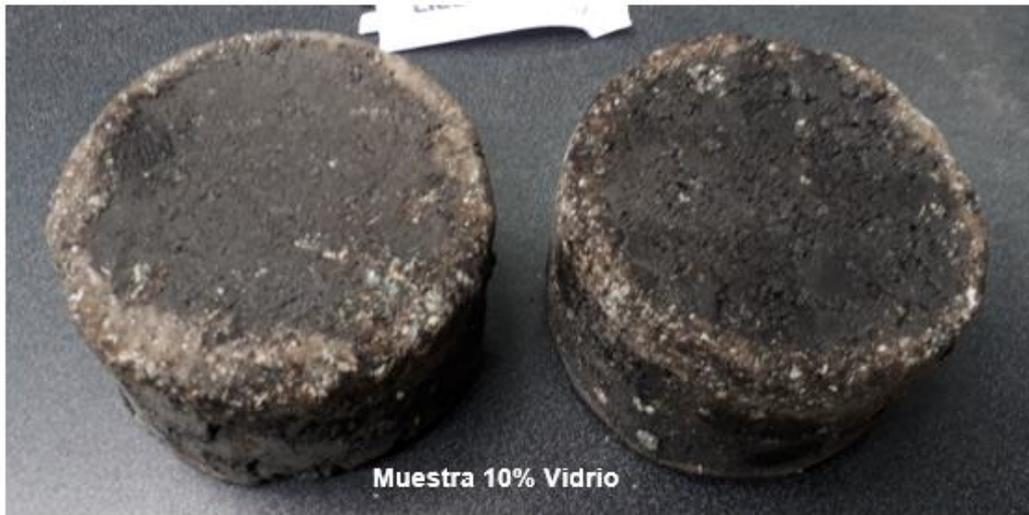
Figura 105. Muestra 10% vidrio luego del ensayo de abrasión.
