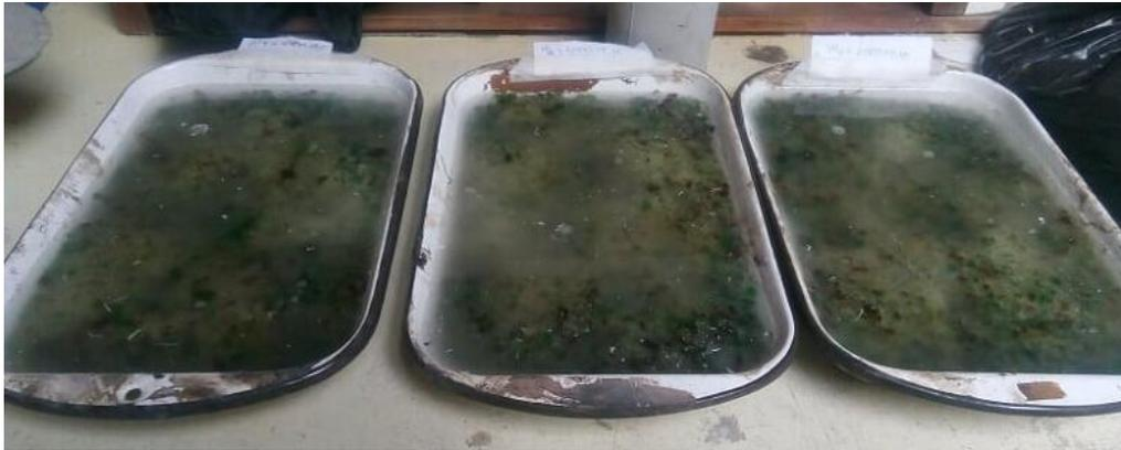
Figura 31. Muestras de vidrio saturadas de agua.
