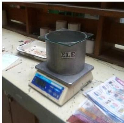
Figura 48. Determinar la masa del recipiente con el contenido.
