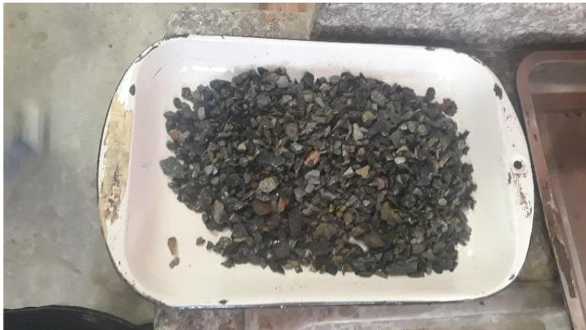
Figura 21. Condición SSS del agregado grueso.
