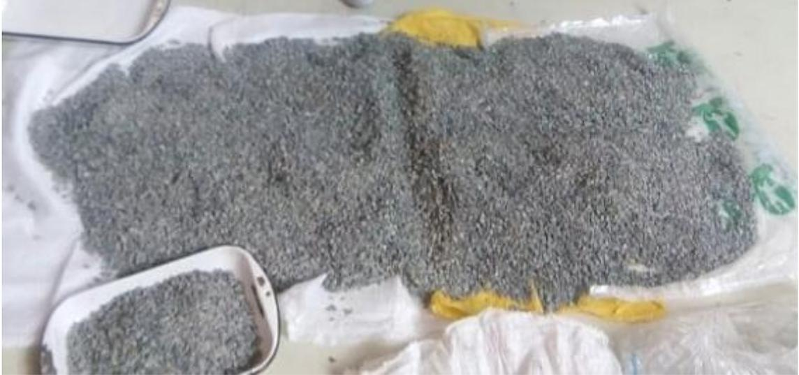
Figura 14. Material a usar para el ensayo de abrasión.
