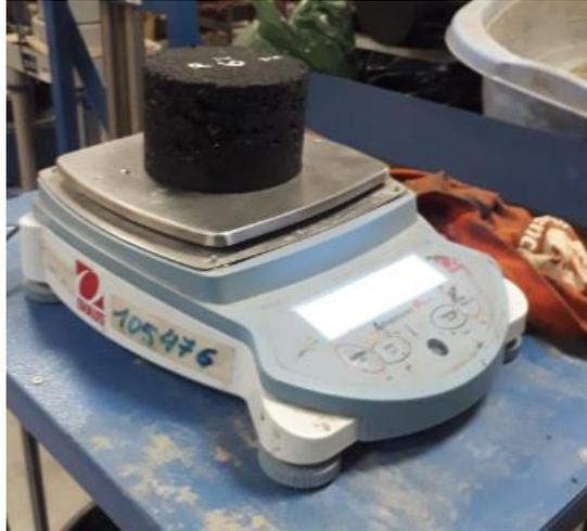
Figura 51. Peso de la briqueta (P1) antes del ensayo.
