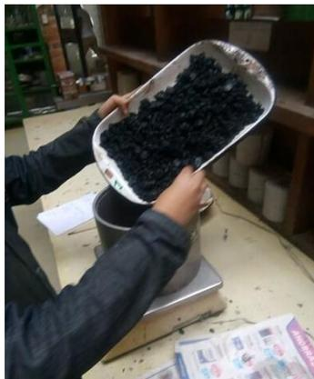
Figura 44. Muestra colocada en el recipiente de vacíos.
