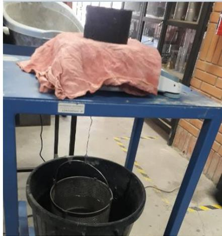
Figura 40. Briqueta pesada en aire luego de haber sido sumergida.
