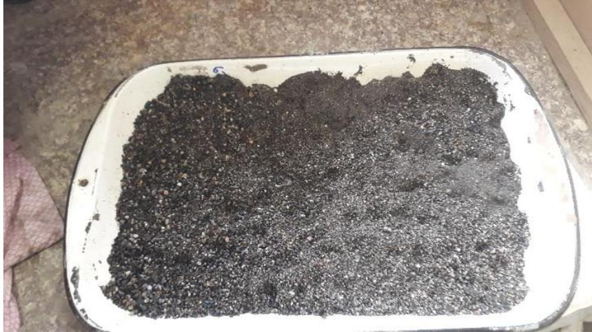
Figura 20. Condición SSS del árido fino.
