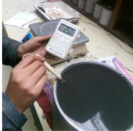
Figura 47. Temperatura del agua luego del ensayo.
