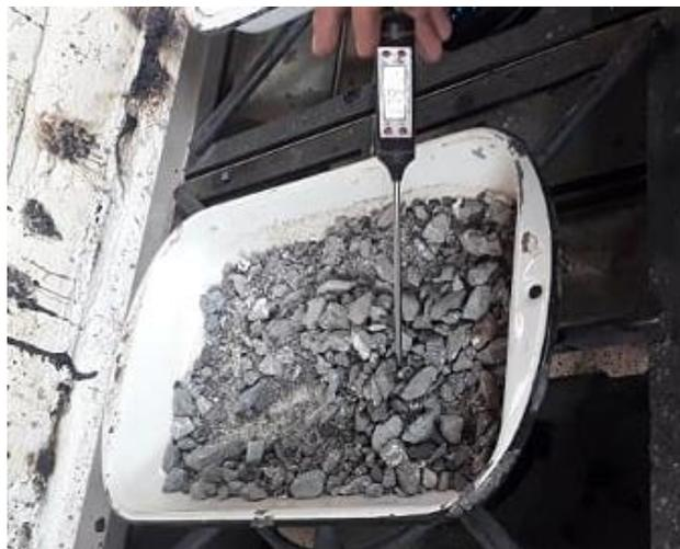
Figura 32. Áridos calientes a temperatura de 179°C.
