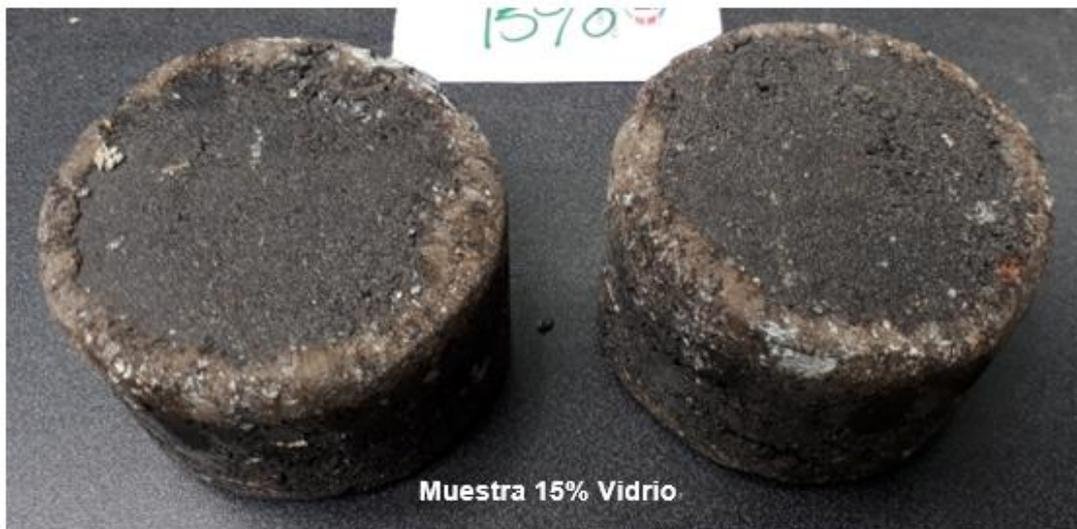
Figura 106. Muestra 15% vidrio luego del ensayo de abrasión.
