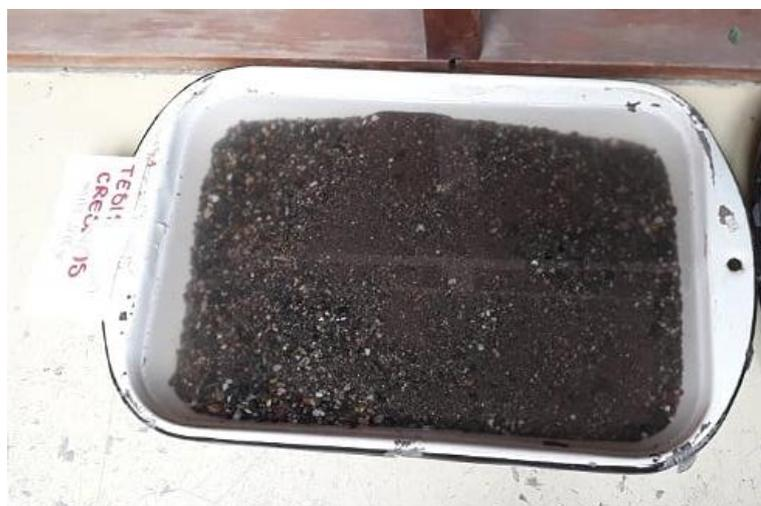
Figura 19. Material fino sumergido en agua.
