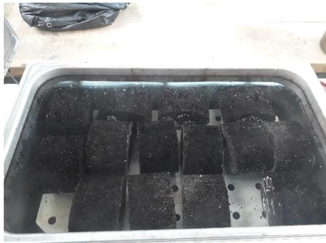
Figura 41. Briquetas colocadas a baño María.
