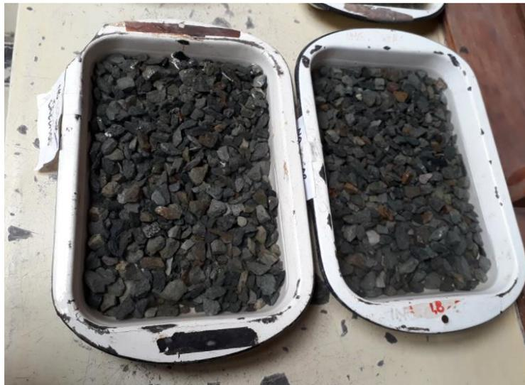
Figura 18. Material grueso sumergido en agua.
