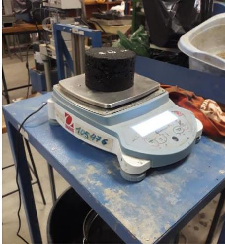
Figura 38. Peso seco en aire de la briqueta.
