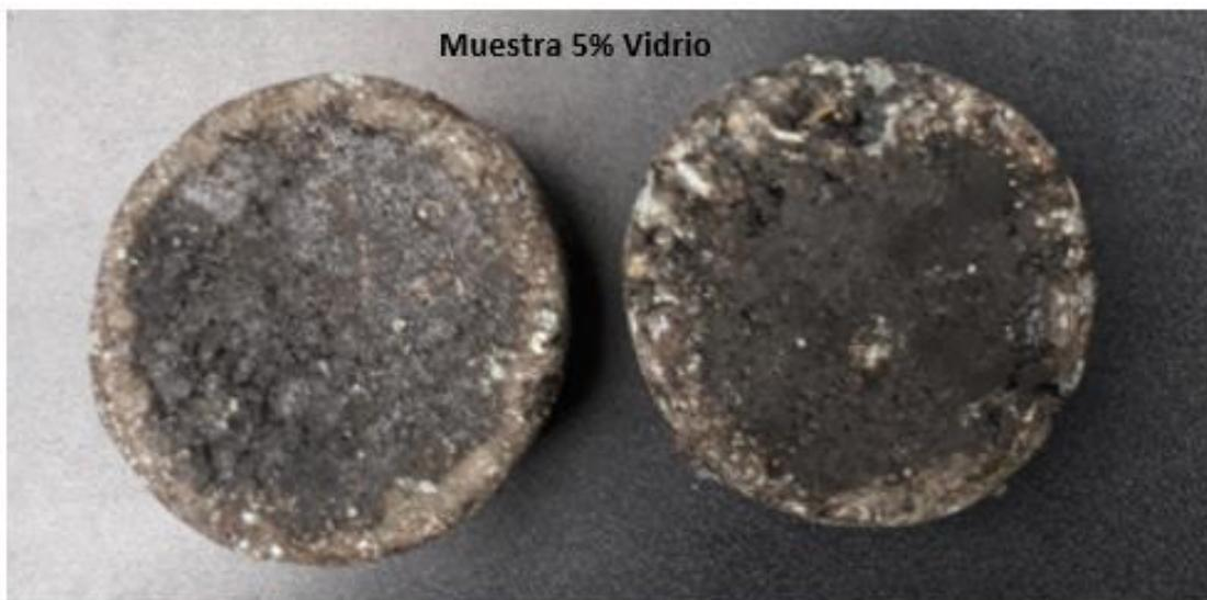
*Figura 104. Muestra 5% vidrio luego del ensayo de abrasión.*
