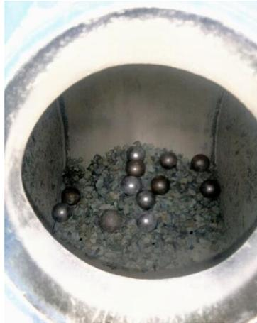
Figura 17. Esferas colocadas dentro de la máquina de Los Ángeles.
