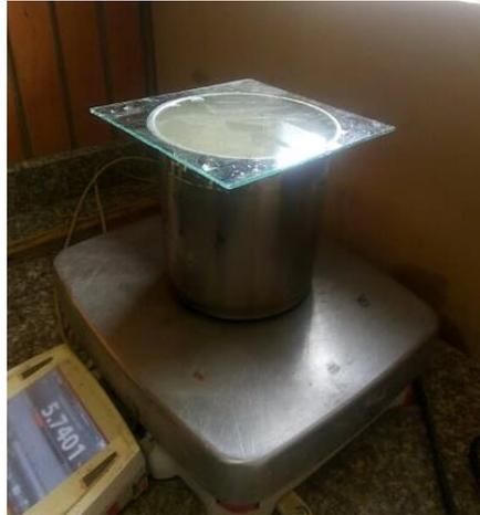
Figura 22. Peso del picnómetro más agua y muestra.
