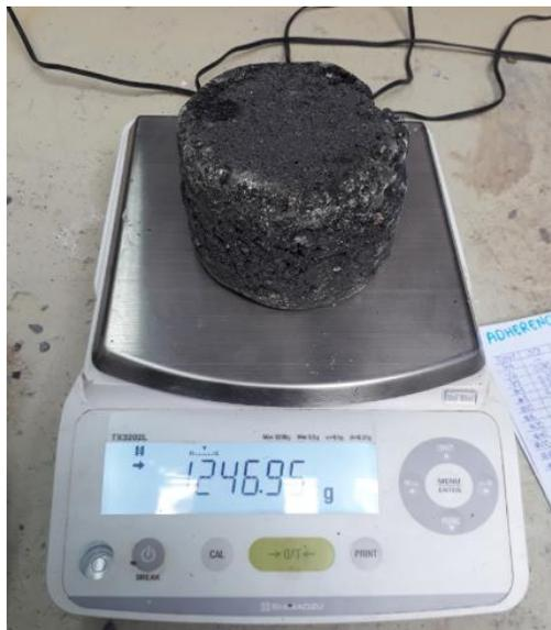
Figura 52. Peso de la briqueta (P2) luego del ensayo.
