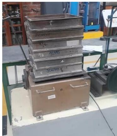
Figura 12. Análisis Granulométrico, Tamices gruesos.
