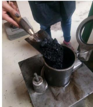
Figura 35. Introducción de la mezcla asfáltica en el molde.
