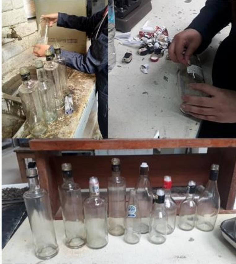
Figura 24. Lavado y secado de botellas.
