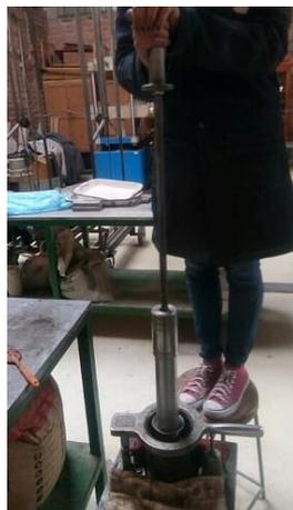
Figura 36. Compactación de las briquetas.
