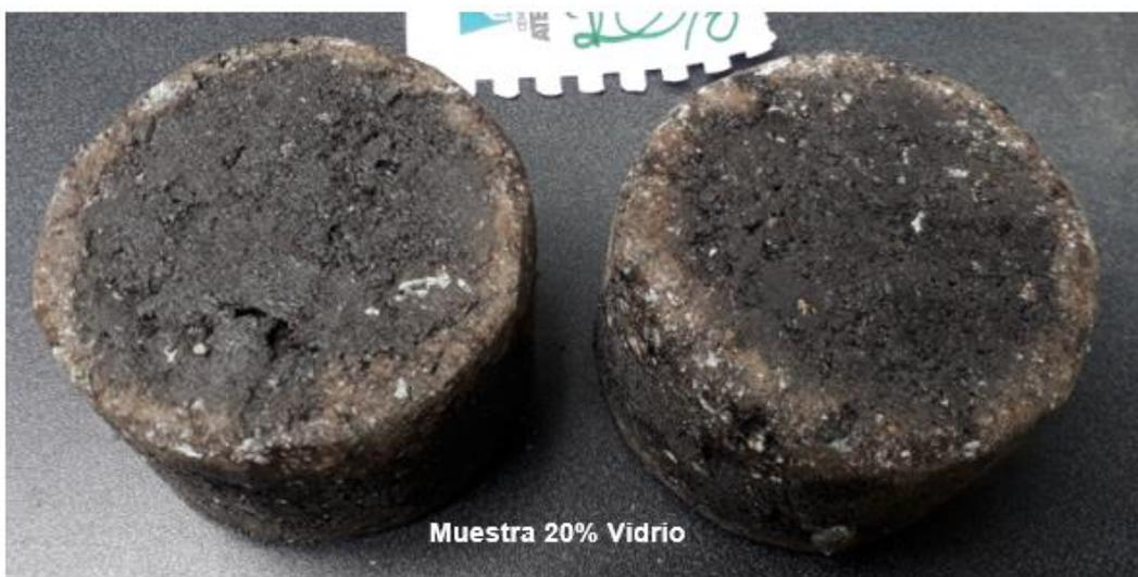
Figura 107. Muestra 20% vidrio luego del ensayo de abrasión.
