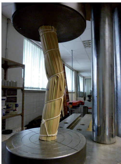
Figura 8. Ensayo a flexión de rollos de totora, 2018. Elaboración propia.
