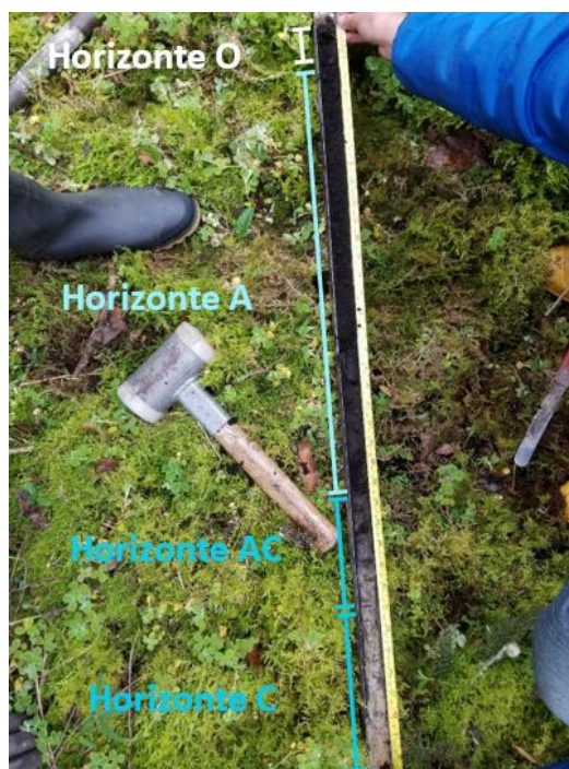
Ilustración 7: Medición del espesor de horizontes del suelo mediante barreno de media caña
