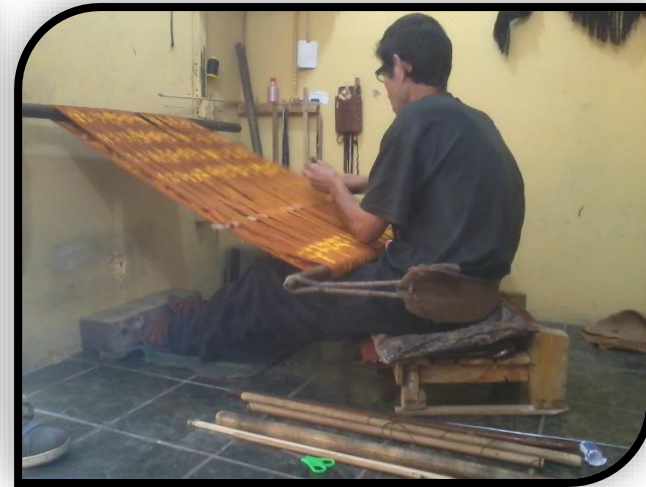
La urdiembre es colocada en orden en el telar de cintura. (19) (20) foto autor
