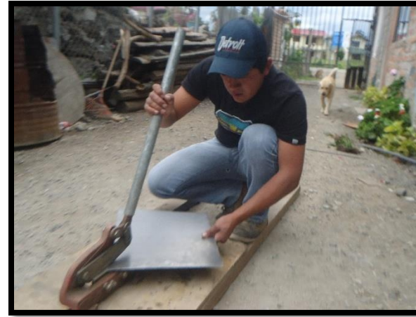
Cortado de planchas de metal. (81) foto autor
