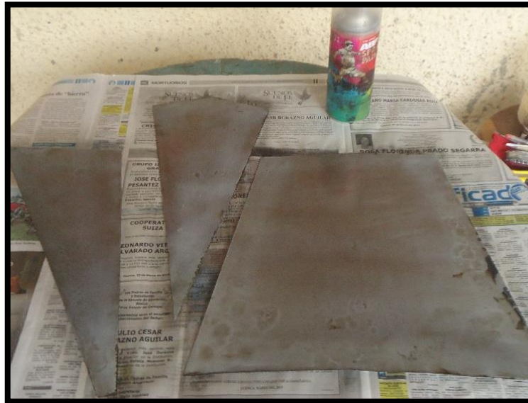
Aislamiento, parte posterior con laca. (83) foto autor
