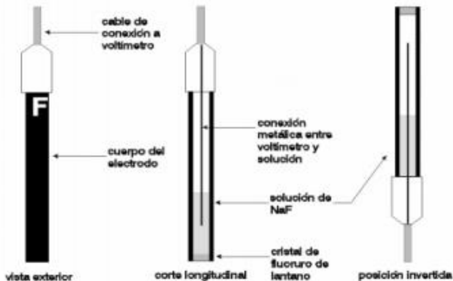
Ilustración 1. Vista exterior y corte longitudinal del electrodo (Rigalli, Pera, Di, Lucas, Brun, 2007).
