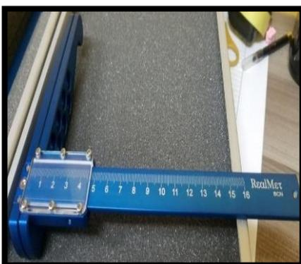
Este calibre se utiliza para medir los diámetros biepicondíleo de húmero y biepicondíleo del fémur y para otros diámetros óseos pequeños. Posee ramas de 10 cm de largo mínimo, cara de aplicación de 1,5 cm de ancho con una precisión mínima de 0,05 cm. Ramas largas que proporcionan suficiente profundidad para abarcar el gancho el ancho del fémur y del húmero (RealMet Institute, 2017)
