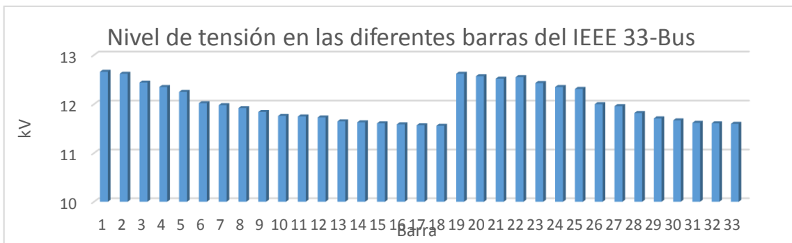
Figura 3-3. Nivel de tensión en las diferentes barras del sistema radial IEEE 33-Bus en kV.
