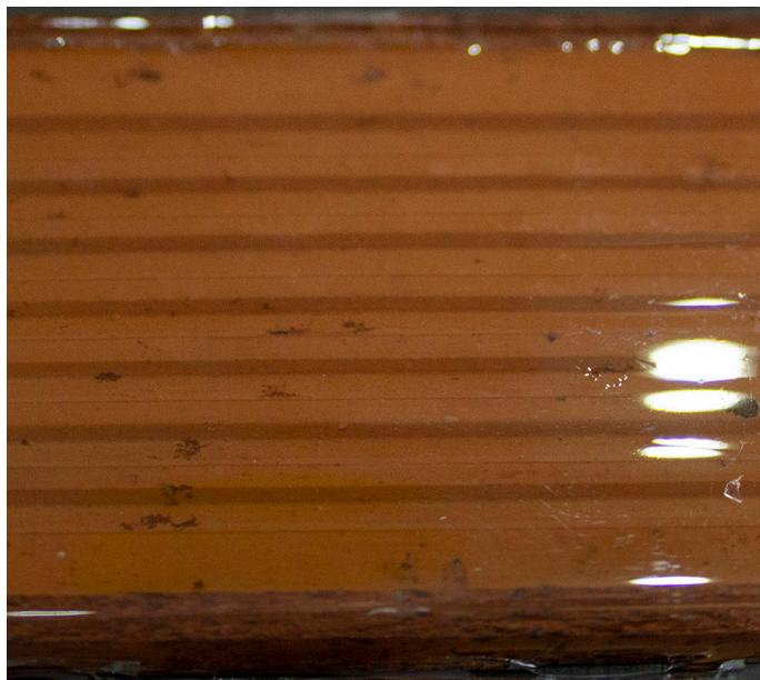
Figura 32. Epóxico con ladrillo industrial con textura
