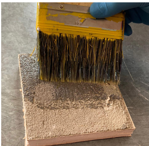
Figura 6. Aplicación de ligante sobre hormigón
