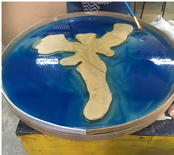
Figura 35. Homogeneización de epóxicos tinturados
