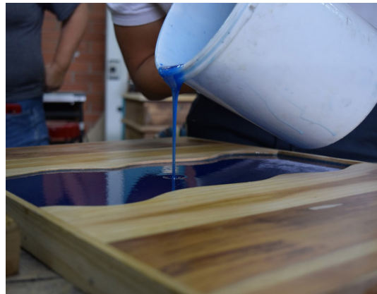
Figura 20. Aplicación de pintura epóxica pigmentada
