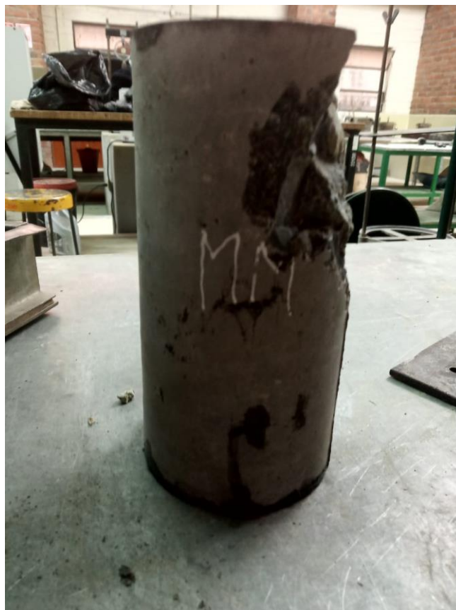
Ilustración 98. Falla frágil en el hormigón con 0.35% de fibra de vidrio de peso.
