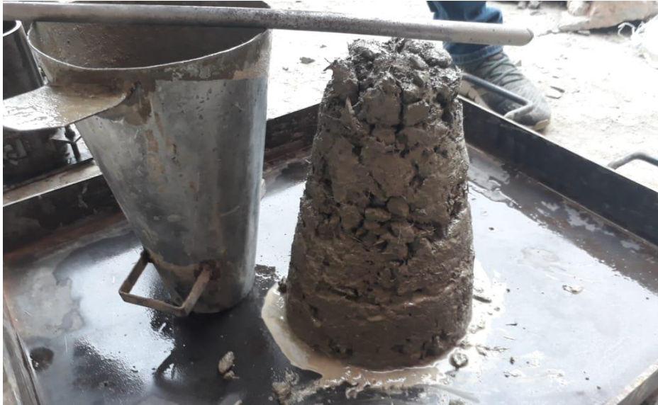
Ilustración 101. Trabajabilidad del hormigón con 0.5% de fibra de vidrio en peso.
