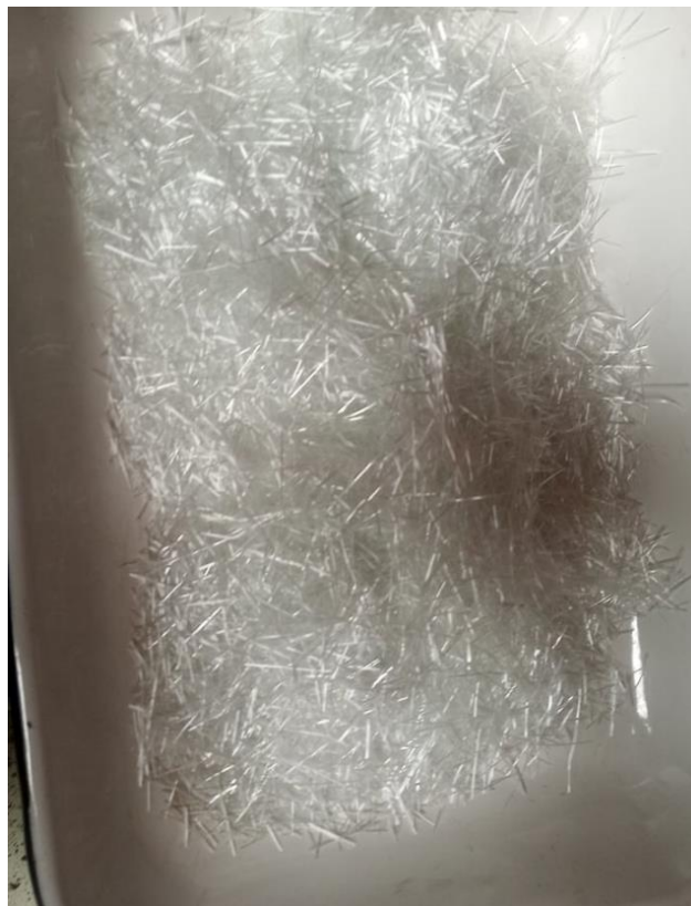
Ilustración 72. Fibra de vidrio tipo AR
