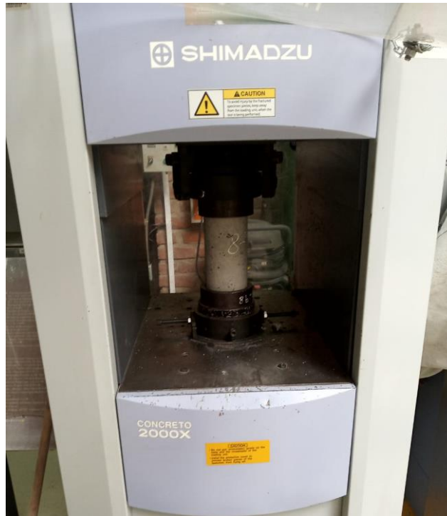
Ilustración 103. Ensayo de resistencia a la compresión del hormigón con 0.5% de fibra de vidrio en peso.
