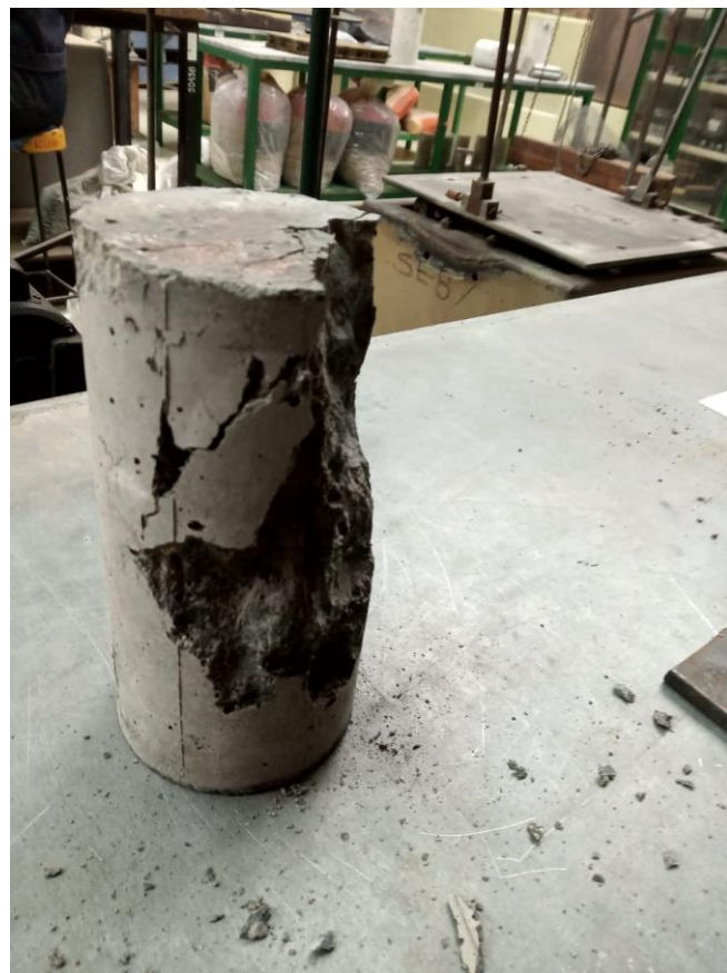
Ilustración 90. Falla frágil – dúctil del hormigón con 0.25% de fibra de vidrio del peso
