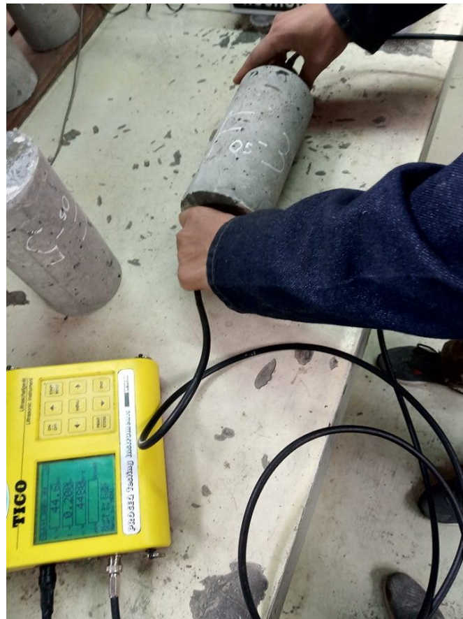
Ilustración 102. Ensayo de velocidad ultrasónica del hormigón con 0.5% de fibra de vidrio en peso.
