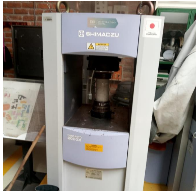
Ilustración 89. Ensayo de resistencia a la compresión de un cilindro con 0.25% de fibra de vidrio de su peso.
