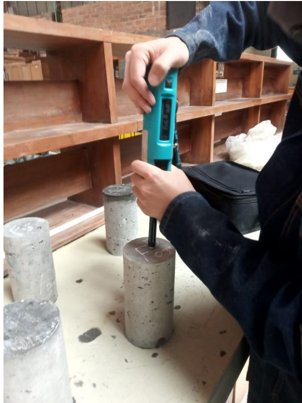
Ilustración 95. Ensayo esclerométrico del cilindro de hormigón con 0.35% de fibra de vidrio del peso.
