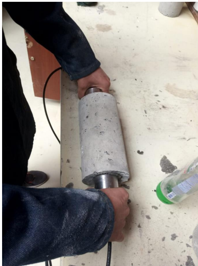
Ilustración 96. Ensayo de velocidad ultrasónica del cilindro de hormigón con 0.35% de fibra de vidrio del peso.
