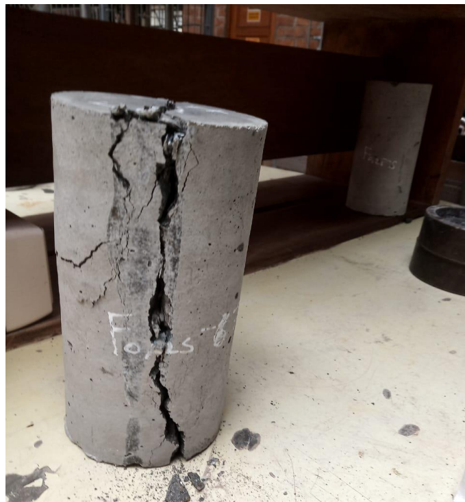
Ilustración 92. Rotura por resistencia a la tracción indirecta del hormigón con 0.25% de fibra del peso.
