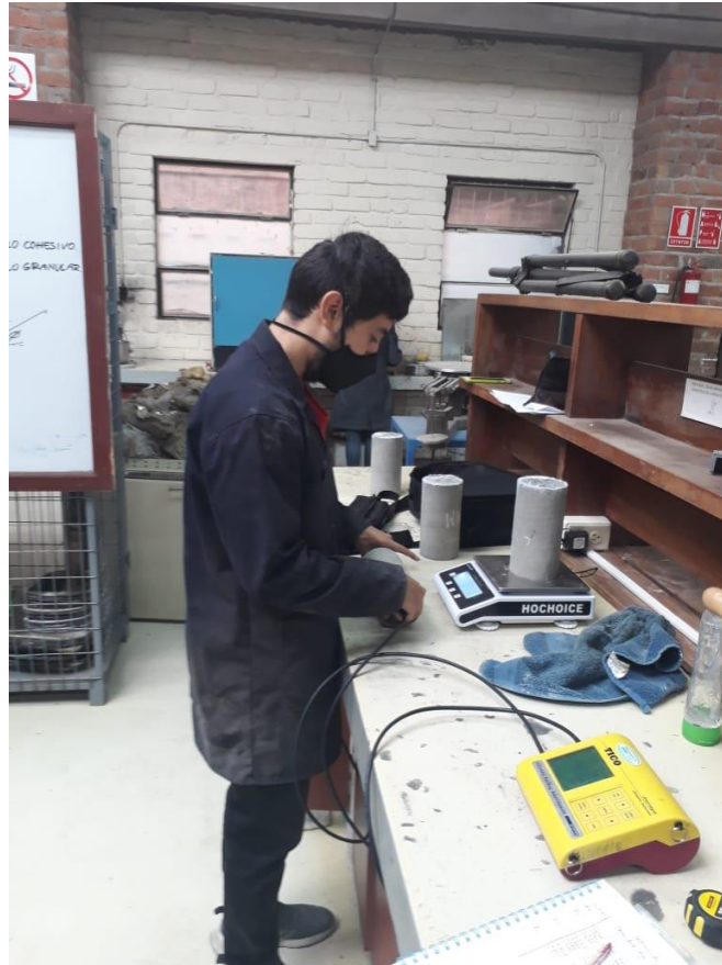
Ilustración 82. Ensayo de velocidad ultrasónica en un cilindro de hormigón Patrón.
