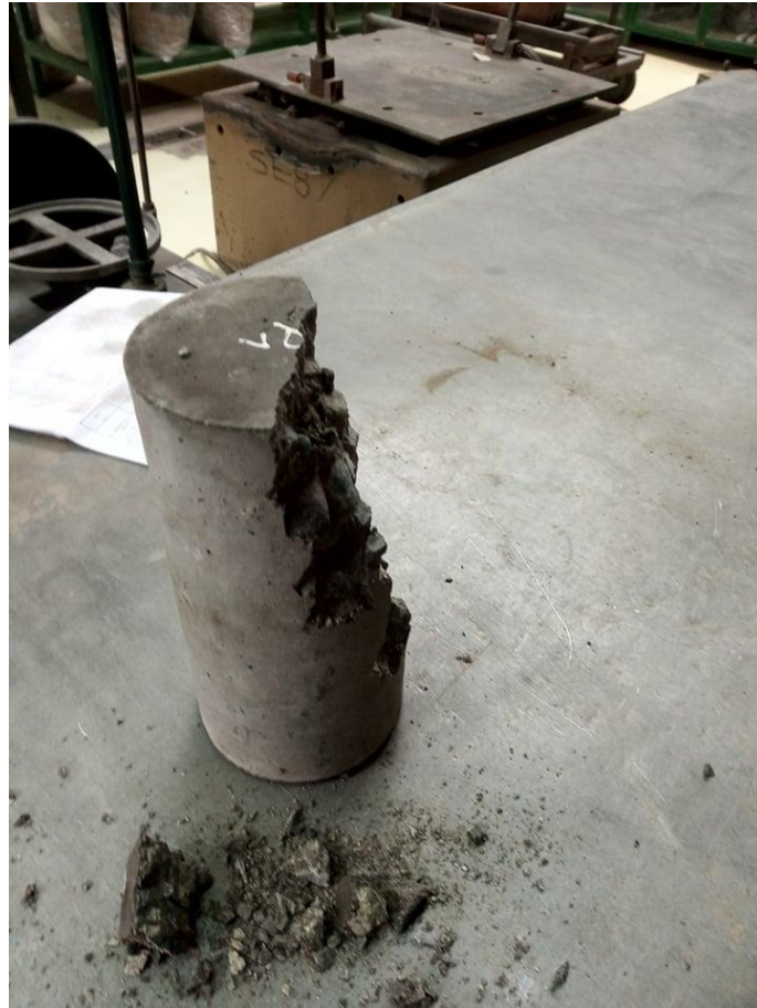
Ilustración 84. Falla frágil conseguida en la prensa hidráulica del hormigón Patrón (Resistencia a compresión).
