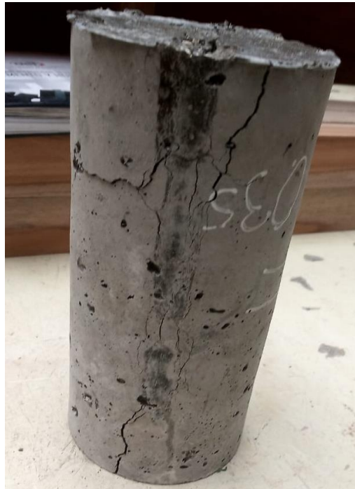
Ilustración 99. Falla producida por el ensayo de tracción indirecta.
