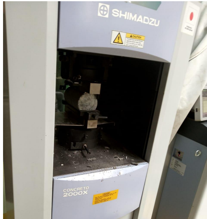
Ilustración 105. Ensayo de tracción indirecta en el hormigón con 0.5% de fibra de vidrio en peso.
