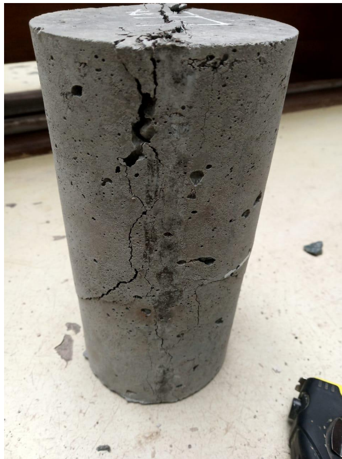
Ilustración 106. Falla producida por el ensayo de tracción indirecta.
