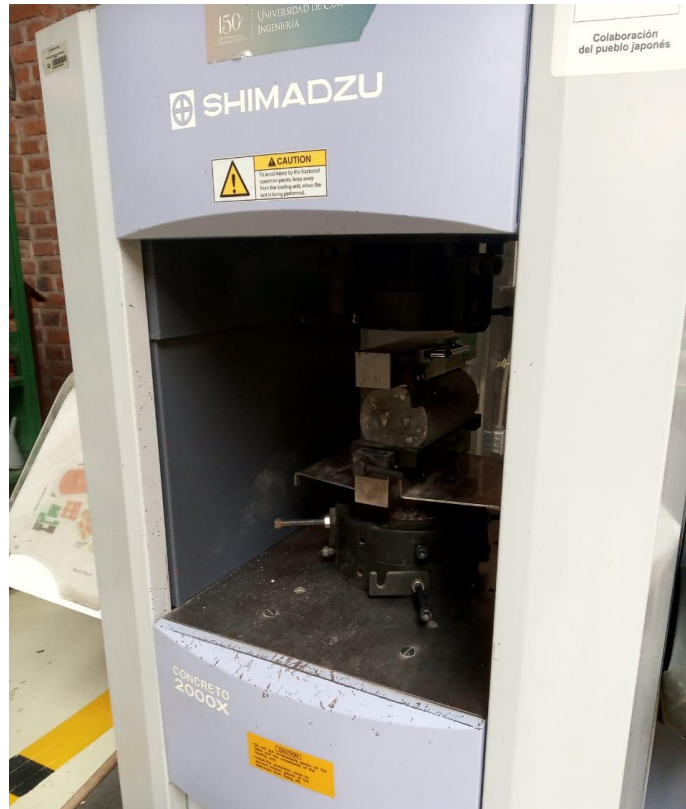
Ilustración 91. Ensayo de tracción indirecta del hormigón con 0.25% de fibra de vidrio del peso.
