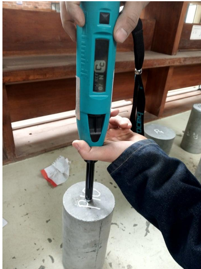
Ilustración 81. Ensayo esclerométrico en un cilindro de hormigón Patrón.
