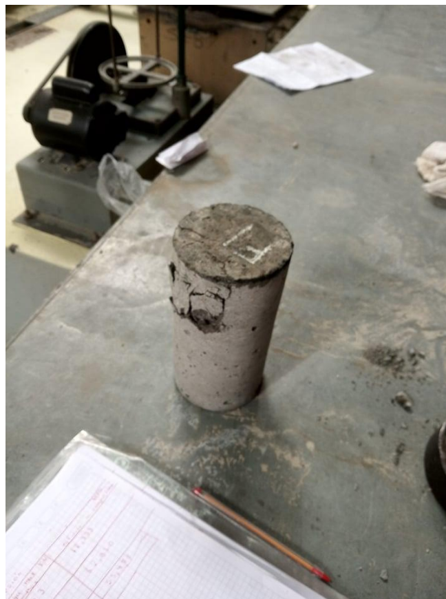
Ilustración 104. Falla dúctil en el hormigón con 0.5% de fibra de vidrio en peso.
