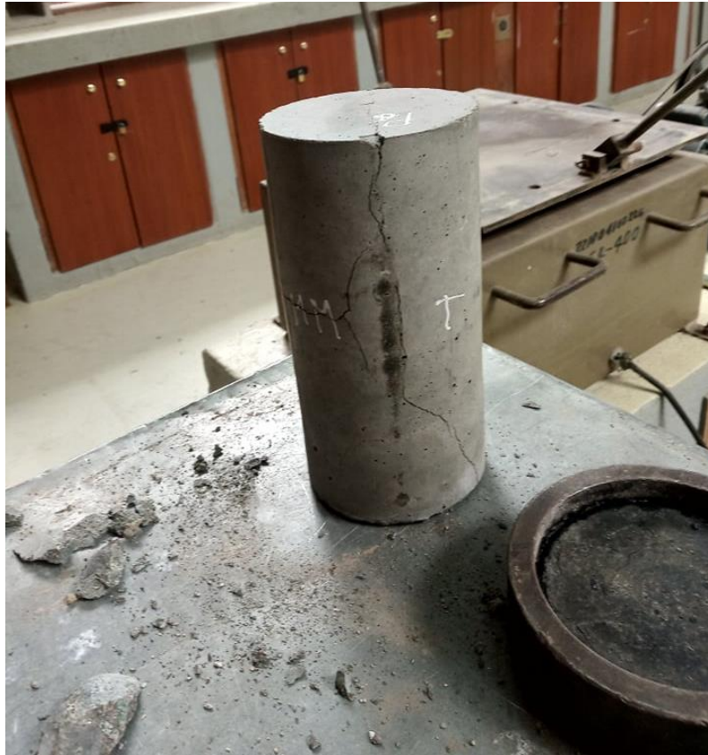
Ilustración 86. Falla conseguida en la prensa hidráulica (Tracción indirecta)
