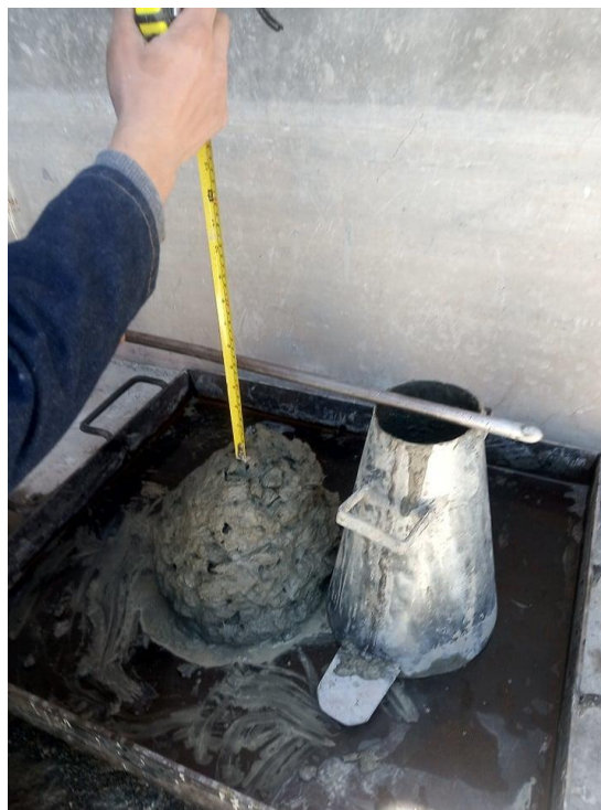
Ilustración 88. Trabajabilidad del hormigón con 0.25% de fibra de vidrio de su peso total
