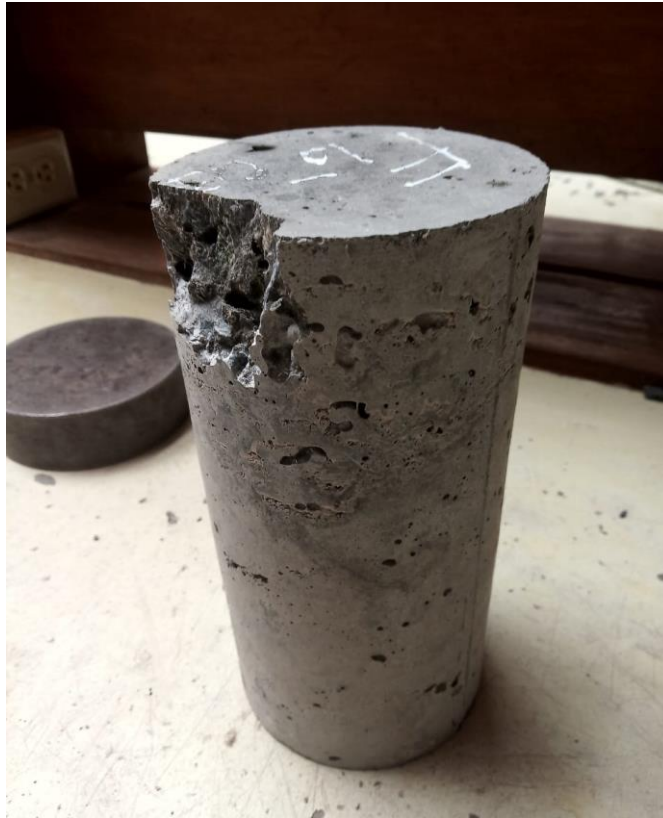
Ilustración 97. Falla dúctil en el ensayo de resistencia a la compresión.
