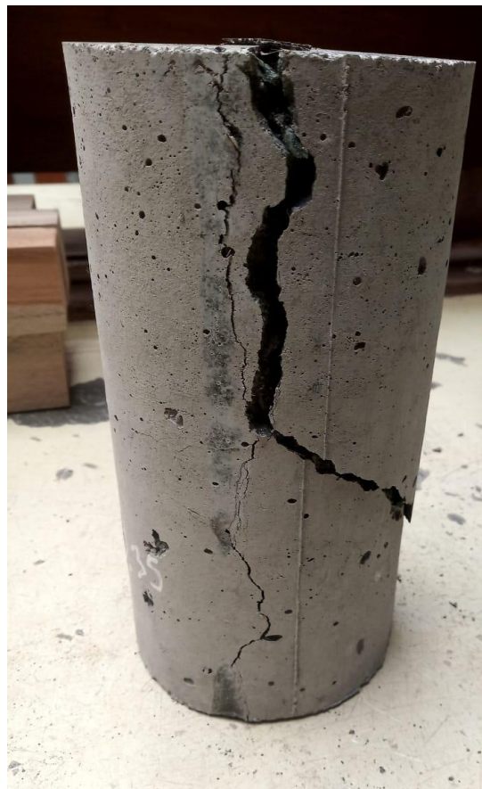
Ilustración 100. Falla producida por tracción indirecta del hormigón con 0.35% de fibra de vidrio de peso.
