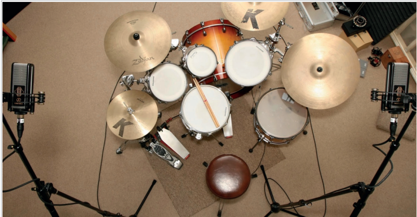
Imagen 37. Micrófonos Sontronix Sigma para platillos configuración par espaciado, imagen cortesía de recordin-ghacks.com.
