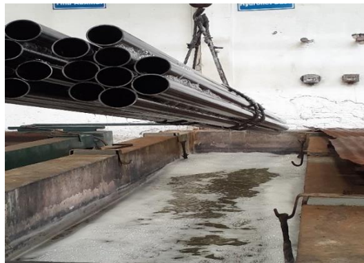
Figura 1.2: Inmersión de tubos en el baño de desengrasado
