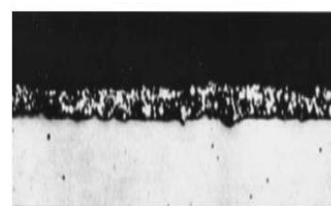
Pintura enriquecida en zinc
