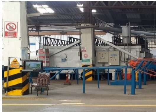
Figura 1.6: Zona de precalentamiento de tubos
