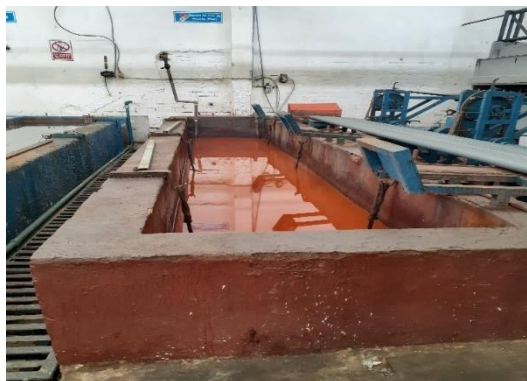
Figura 1.5: Fluxado de tubos de acero
