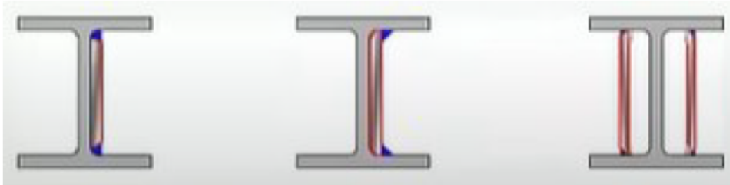
Disposición de planchas adosadas al alma
