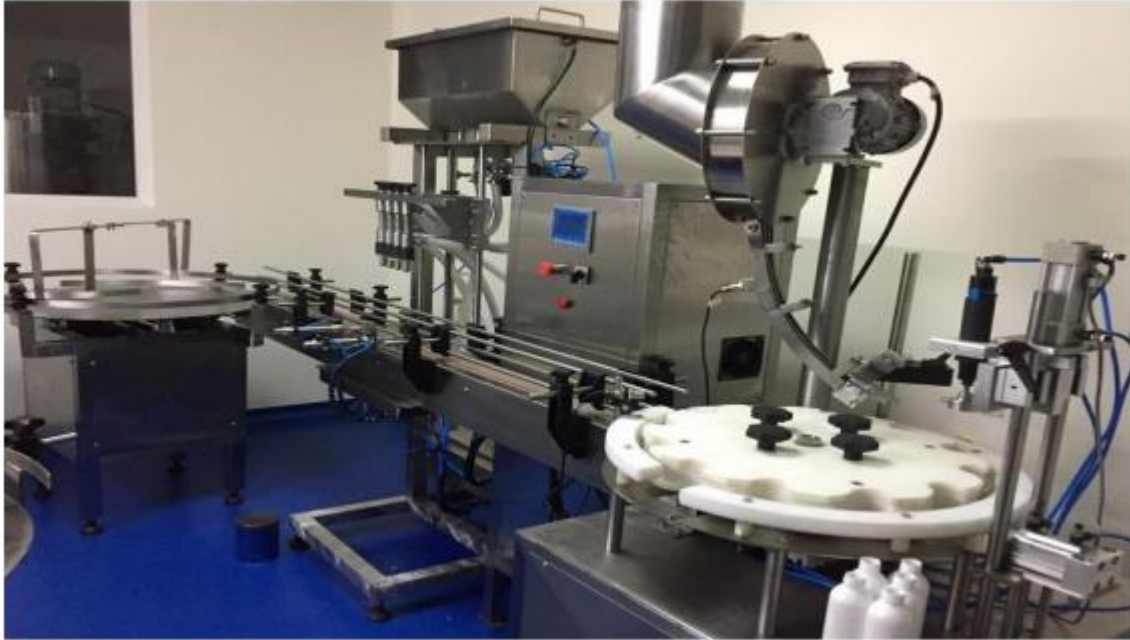
Figura 8: Maquina llenadora monoblock para productos farmacéuticos
