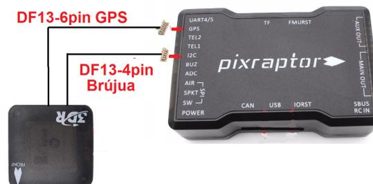
Figura A.2: Conexión de GPS y brújula al controlador *PixRaptor*
