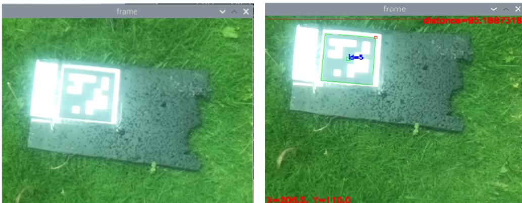
Figura 5.4: Intermitencia en la detección del marcador en frames consecutivos provocada por la influencia de luz natural directa sobre el marcador
