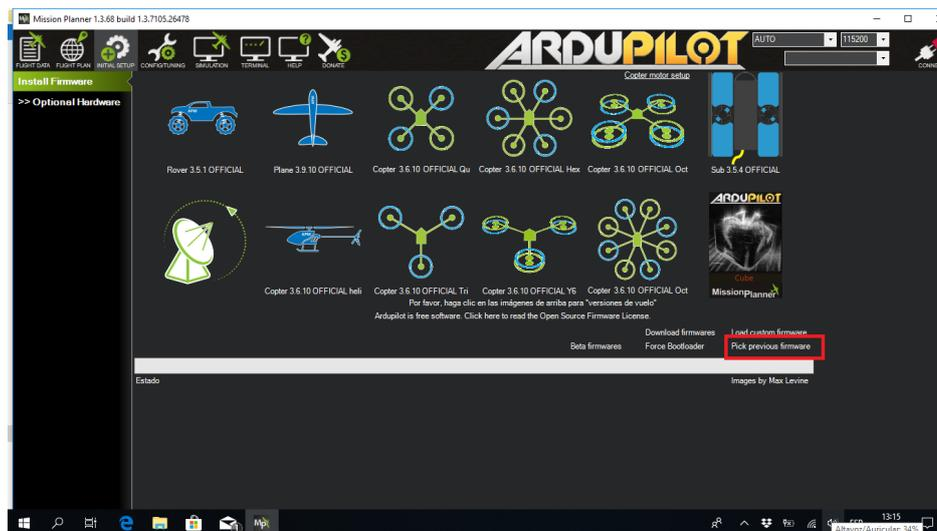
Figura A.10: Instalación de versiones anteriores de *firmware*
