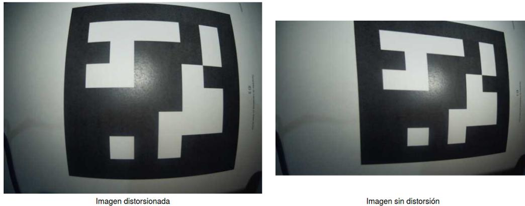
Figura 5.1: Captura antes y después de eliminar la distorsión
