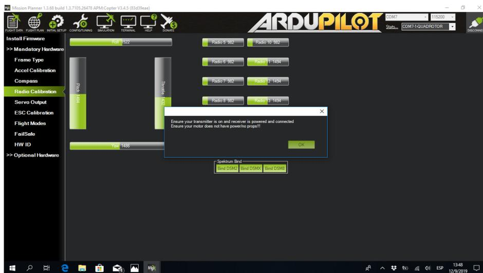
Figura A.15: Detección de canales del radio control
