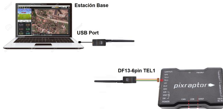
Figura A.4: Conexión de Radio de telemetría
