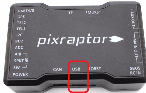
Figura A.7: Puerto micro-USB en el controlador *PixRaptor*
