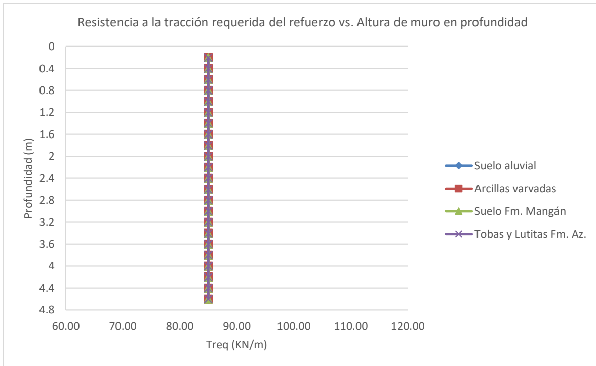
Figura 188: Influencia del tipo de suelo retenido y de fundación en la resistencia a la tracción requerida del refuerzo para el método 1: NCHRP GRS Method
