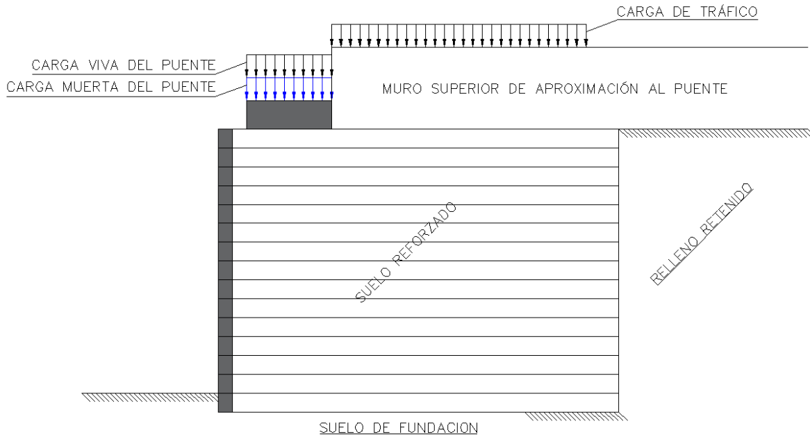
Figura 12: Esquema de cargas actuantes externas sobre el muro para todos los métodos. Modificado de: Berg, R. P., Christopher, B. P., & Samtani, N. P. (2009). Design of Mechanically Stabilized Earth Walls and Reinforced Soil Slopes – Volume I.
