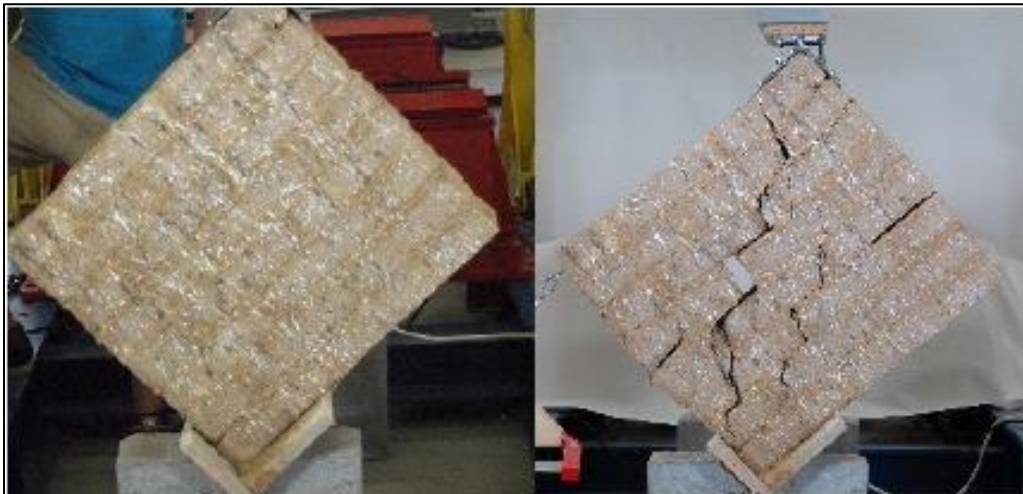
Fig. 14.- Izquierda: Prueba de corte por compresión a 45° del moldeado del adobe - Derecha: Modo de falla del ensayo, fuente (Daudon, Sieffert, Albarracín, Garino Libardi, & Navarta, 2014)
