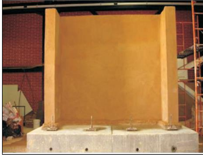
Fig. 29.- Modelo de la pared de adobe a ser ensayada, fuente (Varum H. , Figueiredo, Silveira, Martins, & Costa, 2011)
