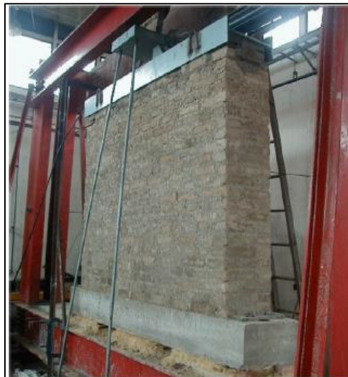
Fig. 35.- Fotografía de la pared llena a ser ensayada, fuente (Reyes, y otros, 2018)
