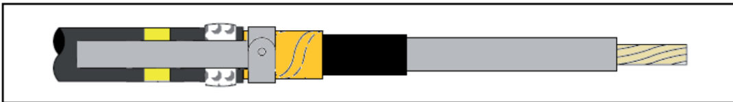
Figura 3. 22 Enrollado de anillo de compresión [33]
