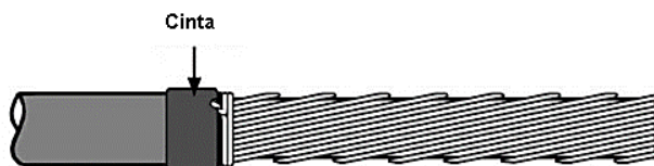
Figura 3. 63 Colocación de cinta [38]
