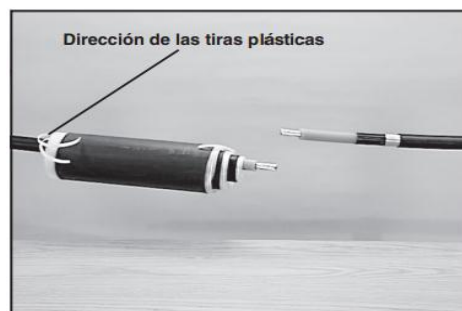
Figura 3. 35. Un Tubo contráctil en frío dentro del otro para espacios reducidos [35]
