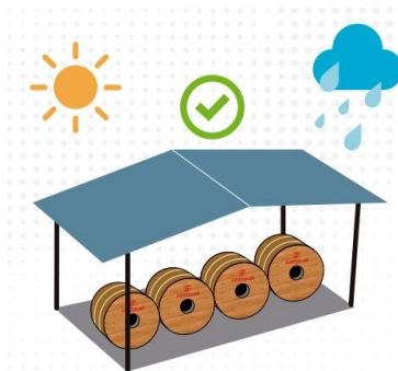
Figura 3. 1. Almacenamiento de las bobinas protegiéndolas de la intemperie y de la humedad del suelo. [11]
