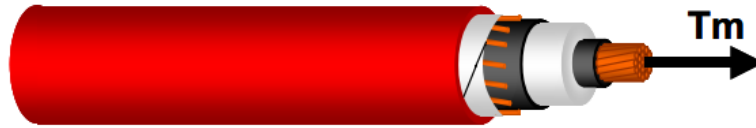
Figura 3. 3. Cables halados mediante perno de tracción.[28].
