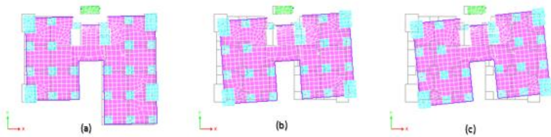
Figura 97. Vista en planta del modo de vibración 1 correspondiente al Caso 5. a) Segunda Planta. b) Quinta Planta. c) Octava Planta.
