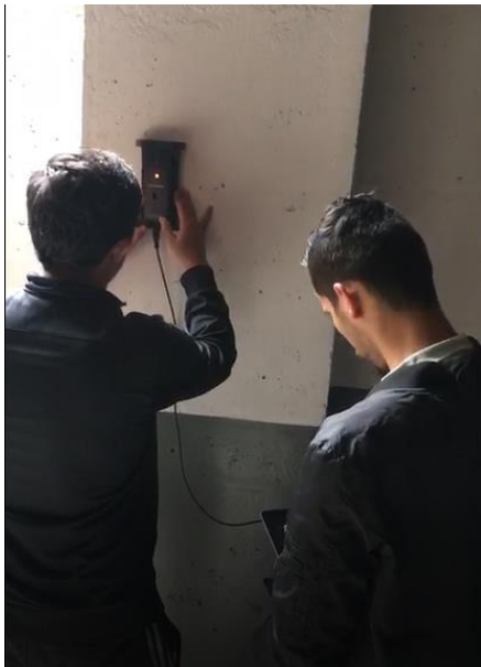
Figura 34. Barrido perpendicular al acero en análisis.
