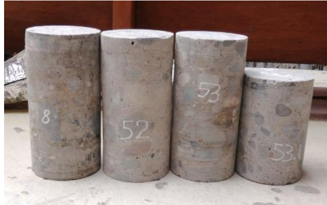
Figura 53. Especímenes de hormigón perfilados.
