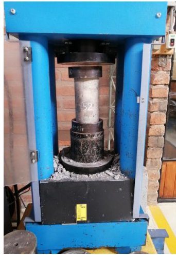
Figura 55. Prueba de Compresión simple
