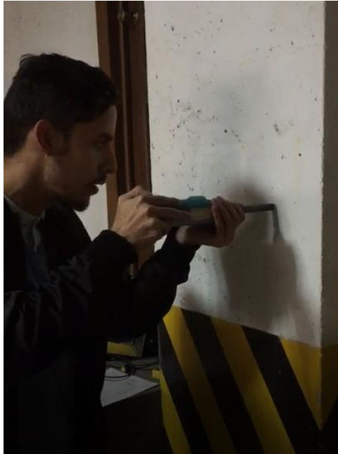
Figura 41. Ensayo de esclerometría con martillo SilverSchmidt.
