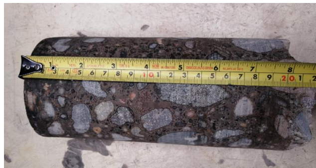
Figura 51. Toma de mediciones de la longitud del espécimen.
