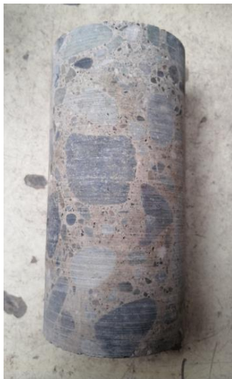
Figura 107. Probeta No:52, proporción de árido grueso en probeta.
