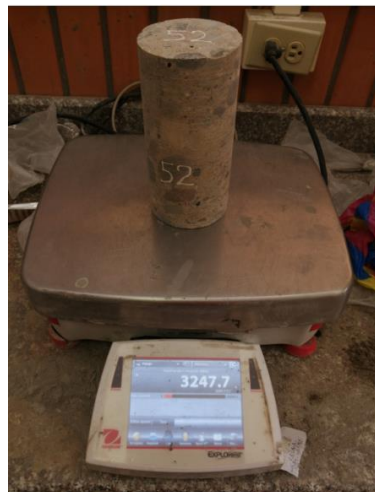
Figura 54. Registro del peso del espécimen de hormigón.
