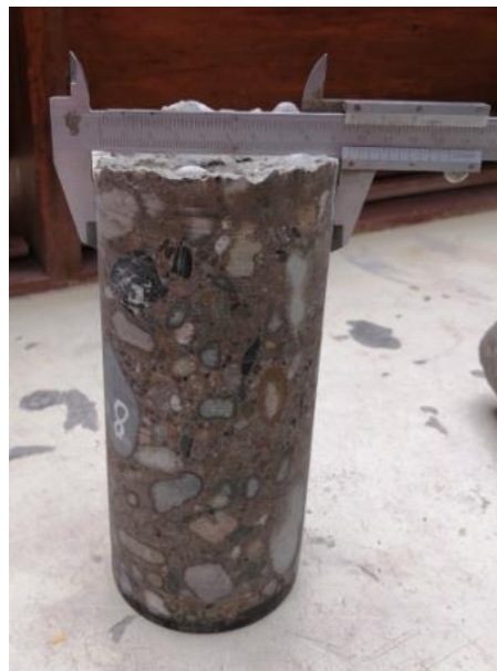
Figura 52. toma de mediciones del diámetro del espécimen.
