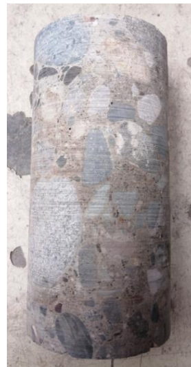
Figura 108. Probeta No:8, proporción de árido grueso en probeta.
