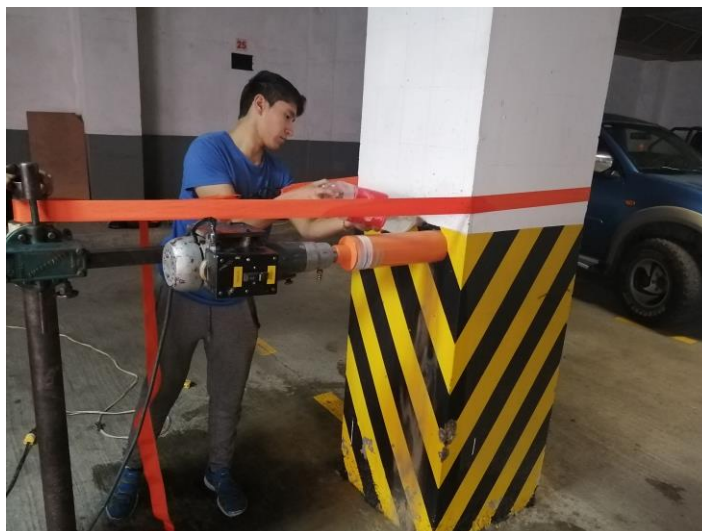
Figura 47. Abastecimiento manual de agua al equipo durante la extracción.
