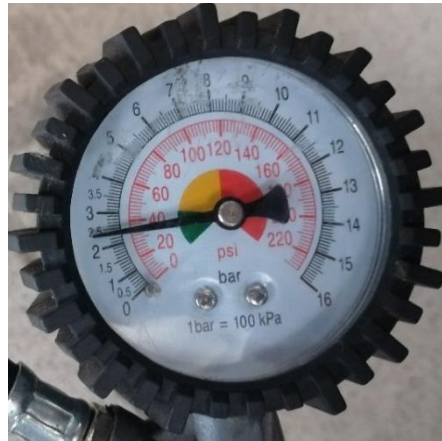
Figura 4.12: Presión de inflado del neumático del Kia Soul EV.
