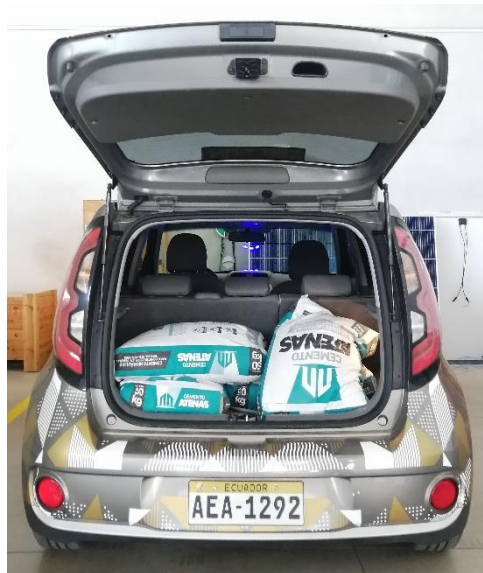
Figura 4.18: VE con carga adicional de 200 kg.
