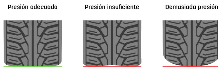
Figura 3.5: Efectos de la presión en el neumático sobre la adherencia [64].
