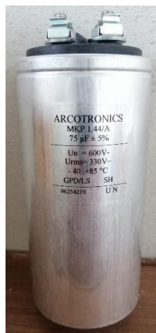
Figura 6.15: Condensador Arcotronics de 75 \mu F .
