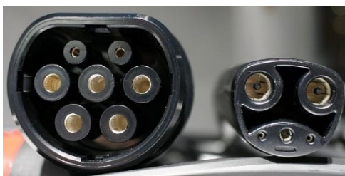
Figura 2.24: Conector Tesla Supercharger en Europa y resto del mundo (izquierda) y Norteamérica (derecha) [37].
